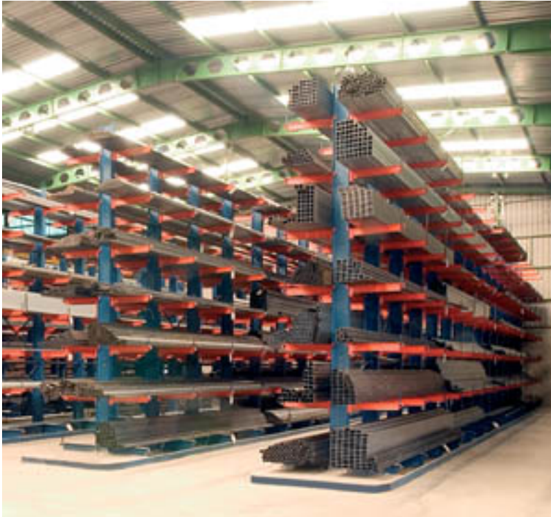
Kuva 3. Ulokehylly varastokäytössä ( www.toyota-forklifts.fi )
