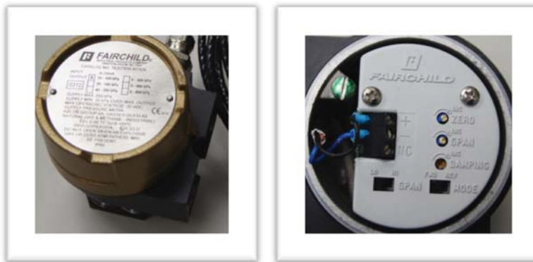
Kuva 3. IP-muunnin ja sen säätöyksikkö
