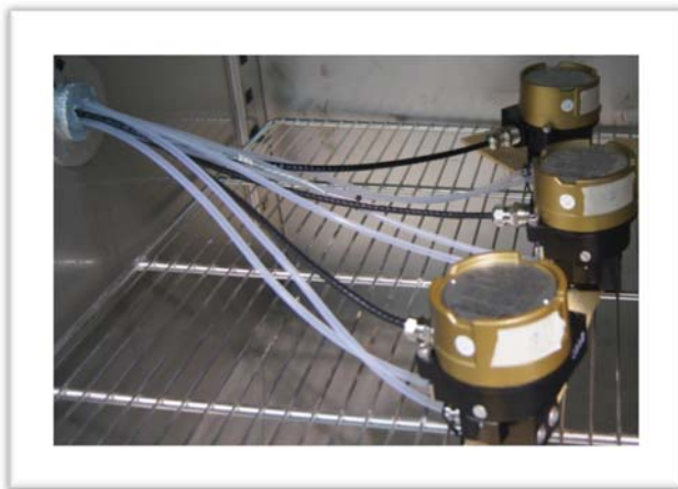
Kuva9. IP-muuntimet ja niiden teflon-letkut
