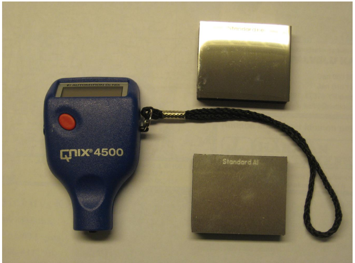
KUVA 8. Mever Oy:n käyttämä kalvonpaksuusmittari
