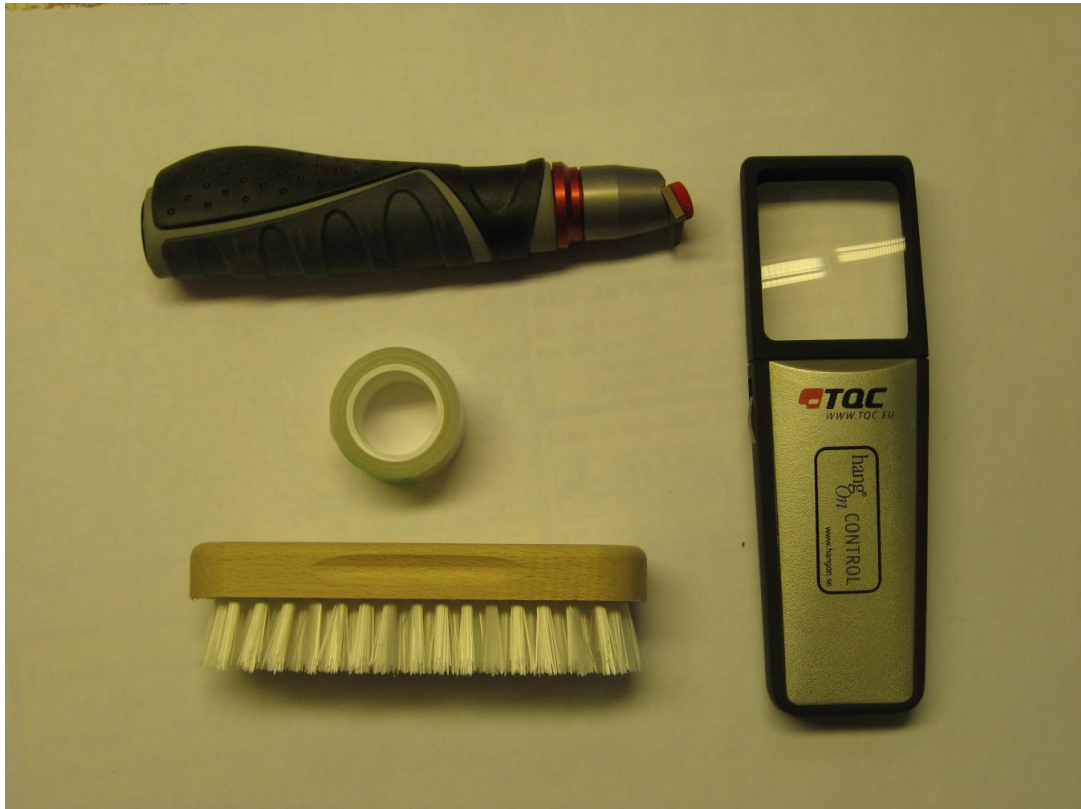
KUVA 9. Hilaristikkokokeeseen tarvittavat laitteet
