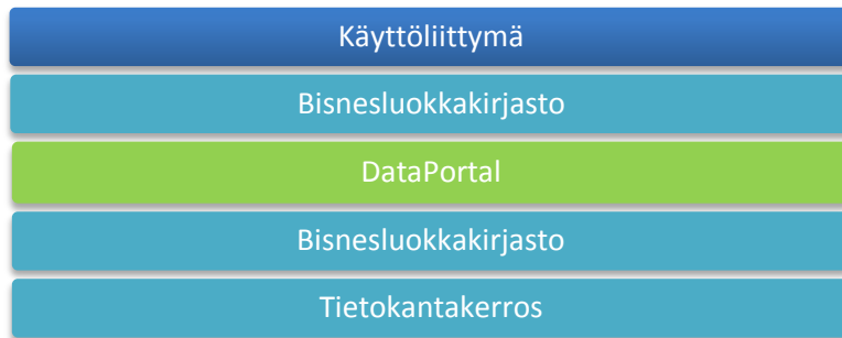
KUVA 1. CSLA:n avulla toteutetun sovelluksen rakenne
