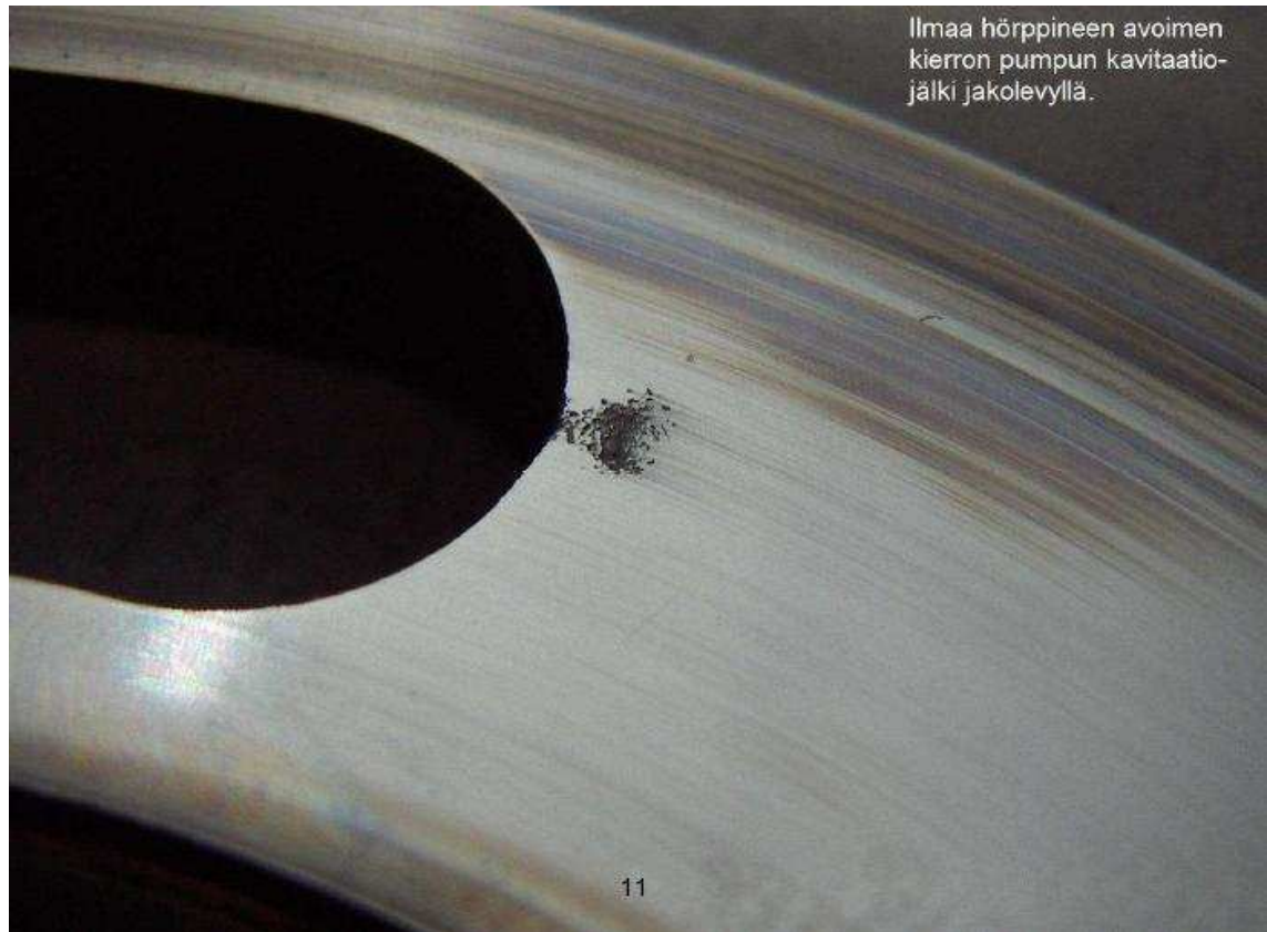
Kuva 2. Ilman aiheuttaman kavitaation jälkiä (Nestepaine 2006).
