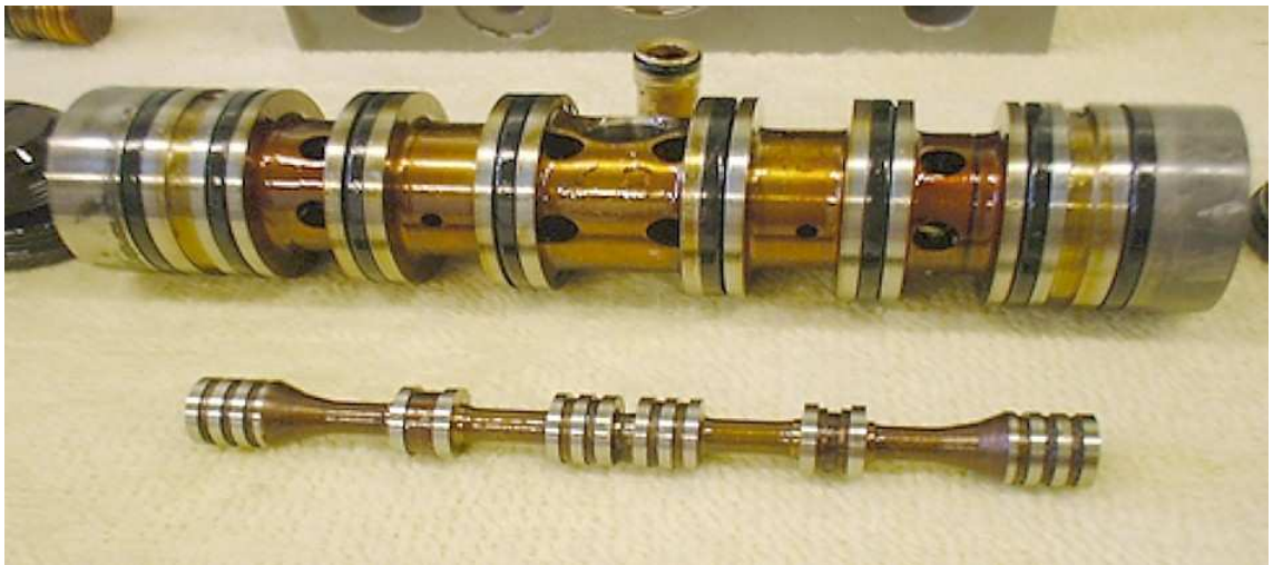
Kuva 1. Lakka ja hartsikerrostumaa venttiilin luistissa.
