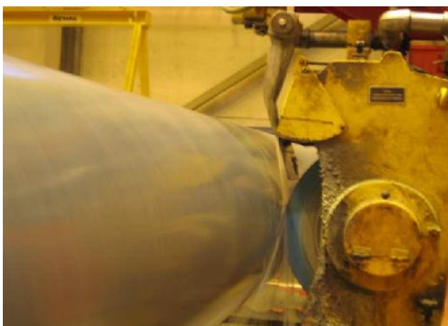
KUVA 5. Telahiomakone, timanttilaikka ja polymeeripinnoitteinen tela
