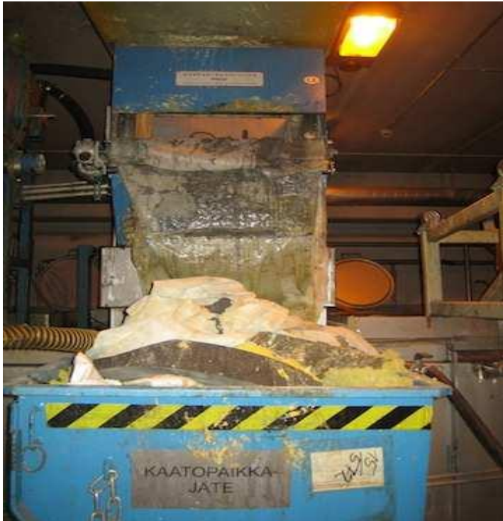
KUVA 7. Nauhasuodatin, josta hiontajäte kulkeutuu jäteastiaan
