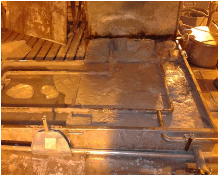
KUVA 8. Saostusallas, josta neste valuu puhtaaseen säiliöön
