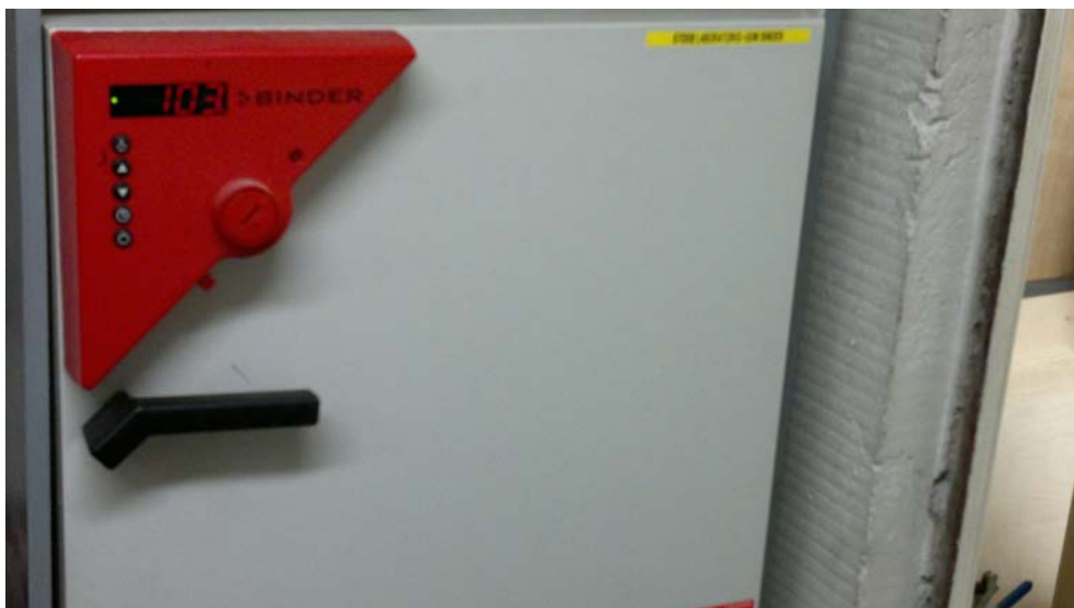
Kuva 11. Kuivauskaappi, jota käytettiin kosteusmittauksissa
