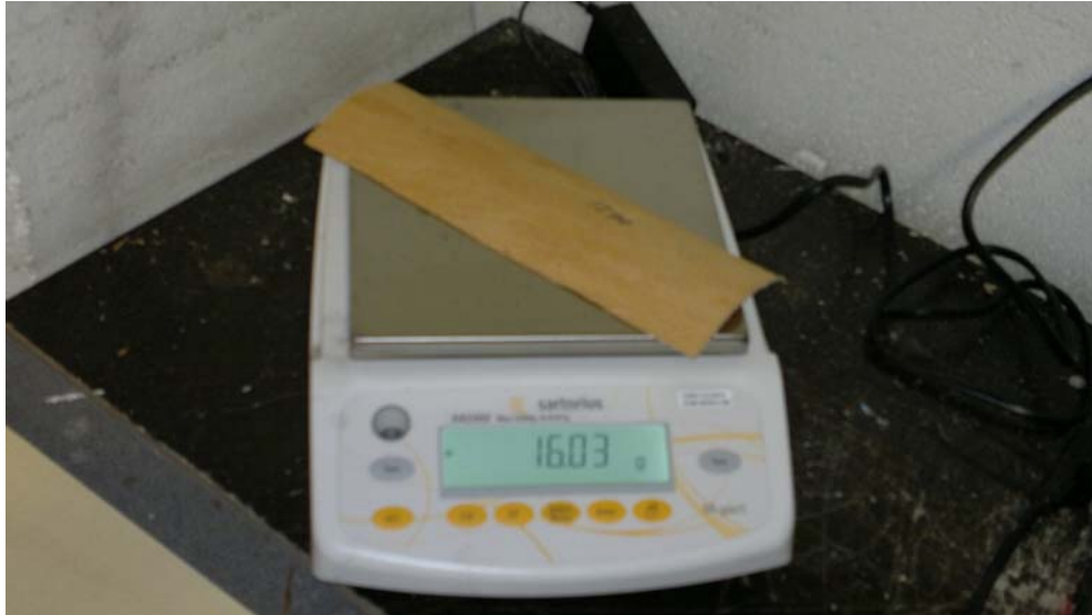
Kuva 10. Kuva kosteusmittauksissa käytetystä vaa'asta ja koeviilun palasta
