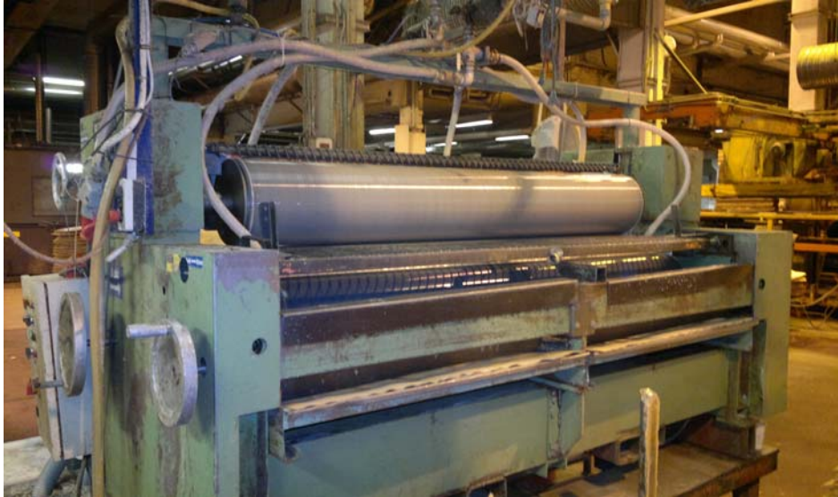
Kuva 5. Liiman levityksessä käytetty telalevitin
