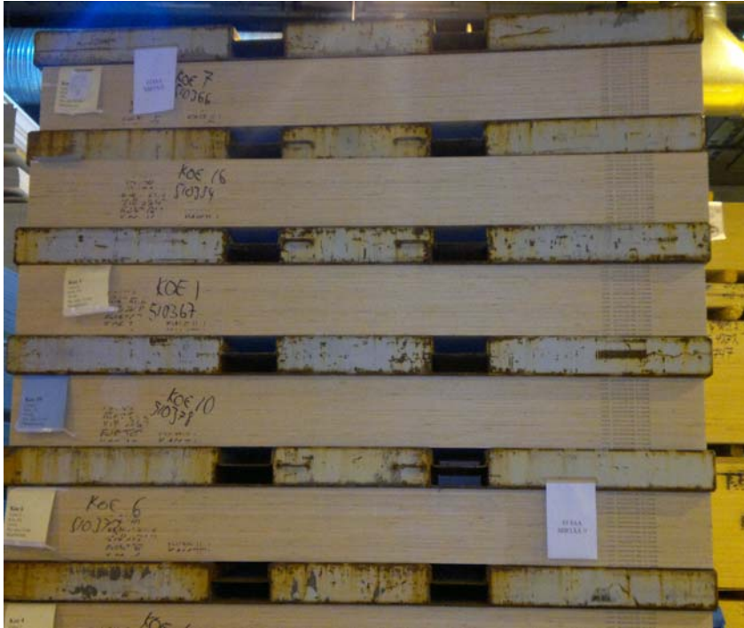
Kuva 7. Koelevyt metallikasettien välissä
