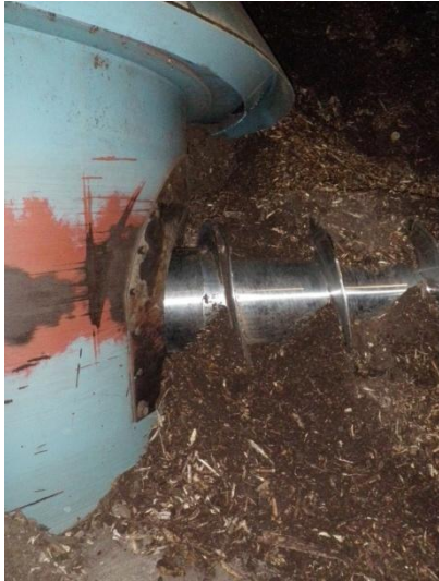
Kuvio 21. Varastosiilon ruuvipurkaimen sisimmät lehdet.
