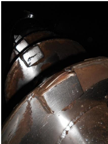
Pa-siilo 1, ruuvipurkaimen kuluneet Miilux-hampaat 7.11.2012.
