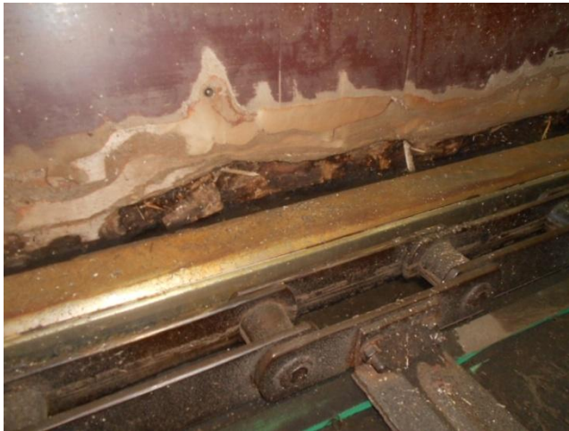
Kuvio 9. Taskupurkaimen kulunut seinälevy.
