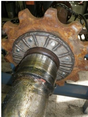
Kuvio 26. Polttoainelinjan kolakuljettimen rattaan taustalaippa.
