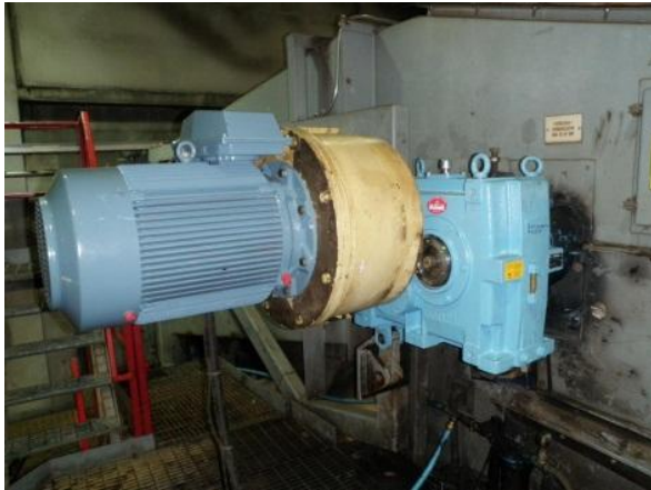
Kuvio 13. Hihnakujujettimen moottori, nestekytin ja vaihde.
