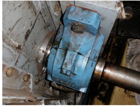
Kuvio 11. Repijätelan laakeri ja seinän / akselin välinen tiivistepesä.
