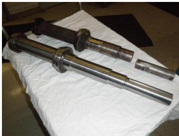
Kuvio 28. Syöttöruuvien katkennut akseli ja uusi IMAGRO M materiaalia.
