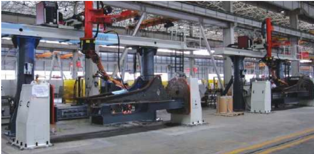
Kuvio 1. Yrityksen robottihitsaussolun laitteistoa vastaava layout. (Otto Arc Systems [viitattu 1.1.2013])
