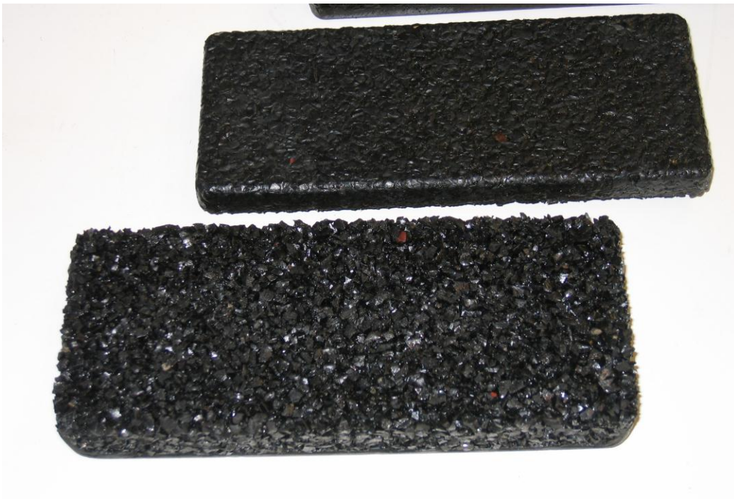
KUVA 9. Kuvassa nähtävissä kumipurun koostumus ja polyuretaanin määrän vaikutus
