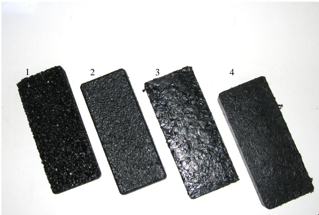
KUVA 8. Kumipurusta valmistettuja koekappaleita
