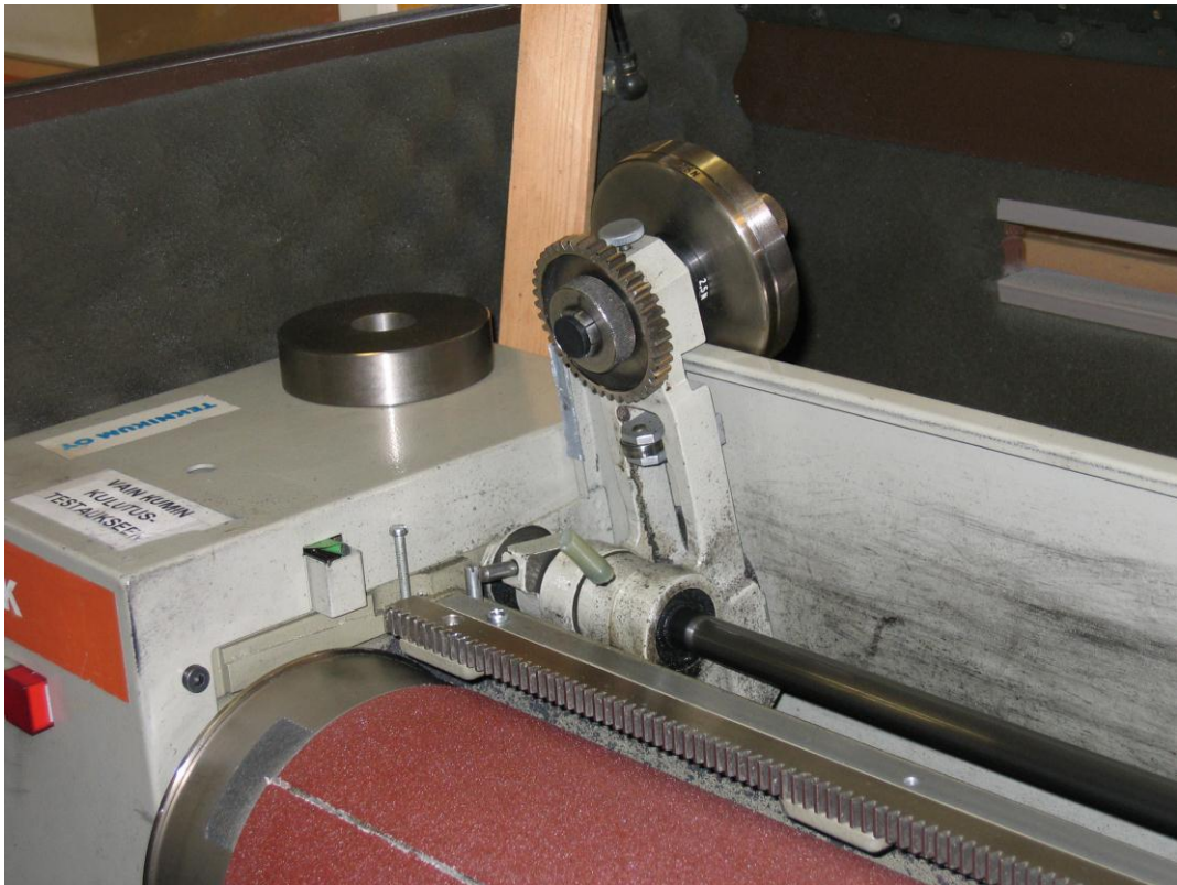
KUVA 8. Kuminäyte on asennettuna paikalleen kulutuskoetta varten
