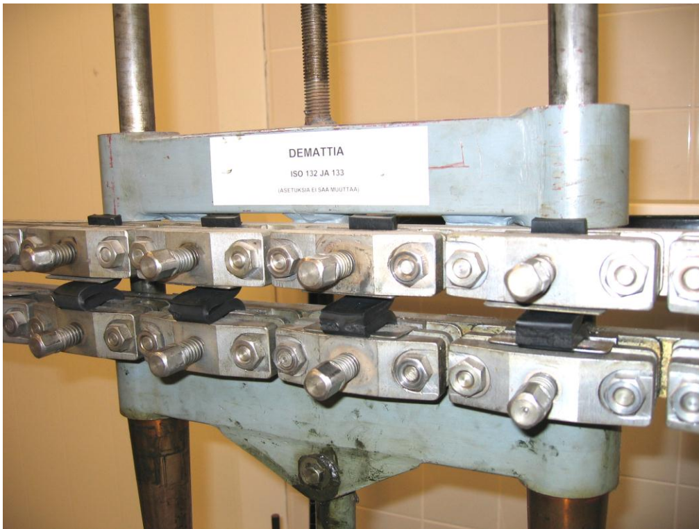
KUVA 7. Laite on ala-asennossaan liuskat kokonaan taittuneena, joista kaksi oikeanpuoleista on murtunut lähes poikki
