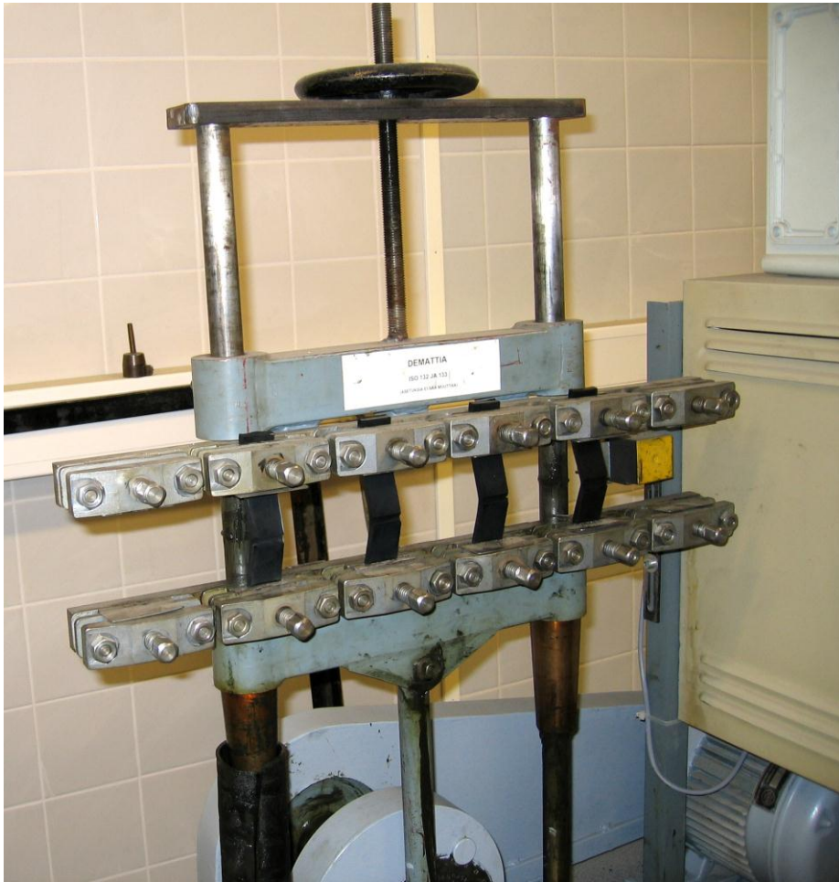
KUVA 5. Neljä testikappaletta kiinnitettynä DeMattia- koneeseen
