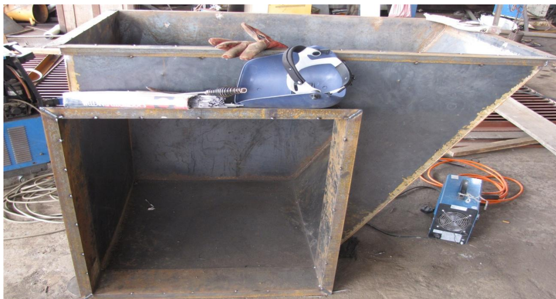
Kuva 2. Esivalmistekanava verstaalla työn alla.
