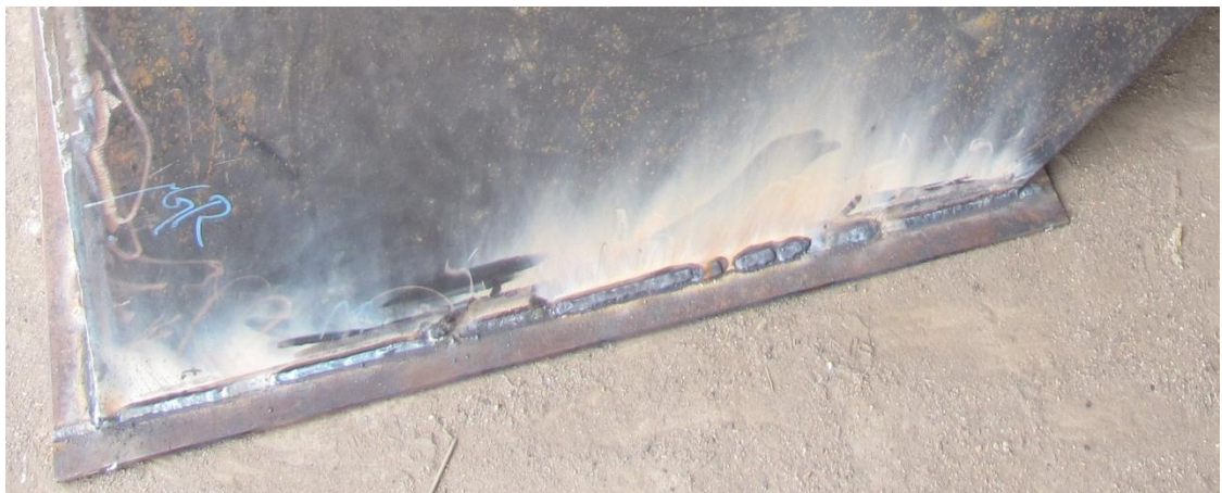
Kuva 23. Tarkastuksessa hylätty hitsausseama.
