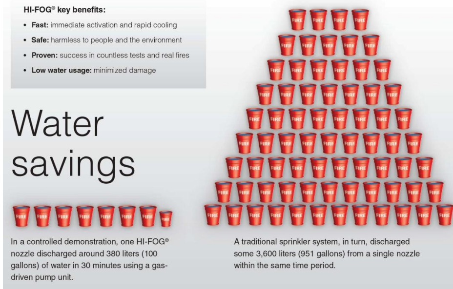
Kuva 6. Yksi korkeapainevesisumujärjestelmän suutin vapauttaa noin 380 litraa vettä 30 minuutissa, kun käytetään kaasupumppuyksikköä. Perinteisen sprinklerijärjestelmän suutin vapauttaa samassa ajassa noin 3600 litraa vettä (6).
