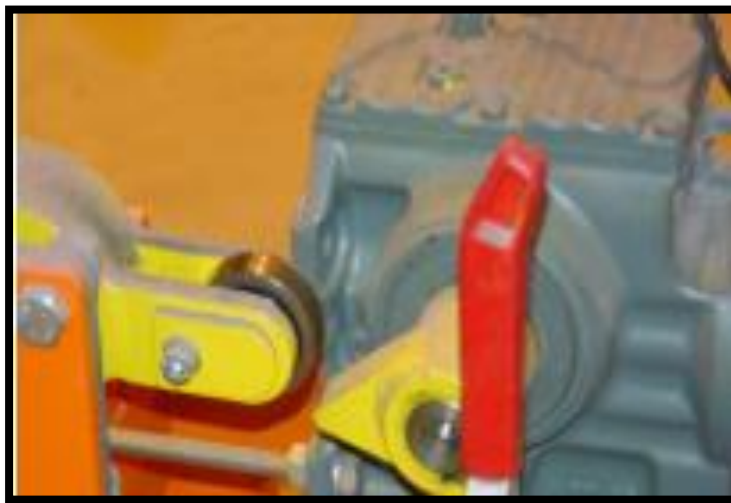
KUVIO 20. Moottorin ja liikettä muodostavan tukivarren kuluva osa
