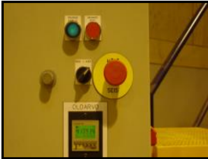
KUVIO 19. Nopeuden ja iskujen määrän säätö sekä koneen käynnistys
