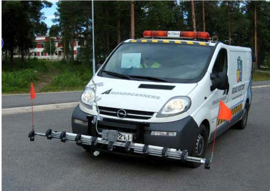
Kuva 23 RoadMaster mittauskalusto (Roadscanners Oy 2011)
