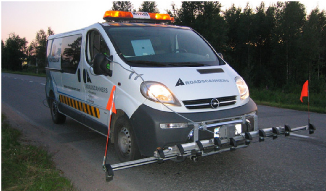
Kuva 13 Ultraäänisensoreihin perustuvalla Roadmaster mittausjärjestelmällä varusteltu mittausauto (Roadex 2001–2011)
