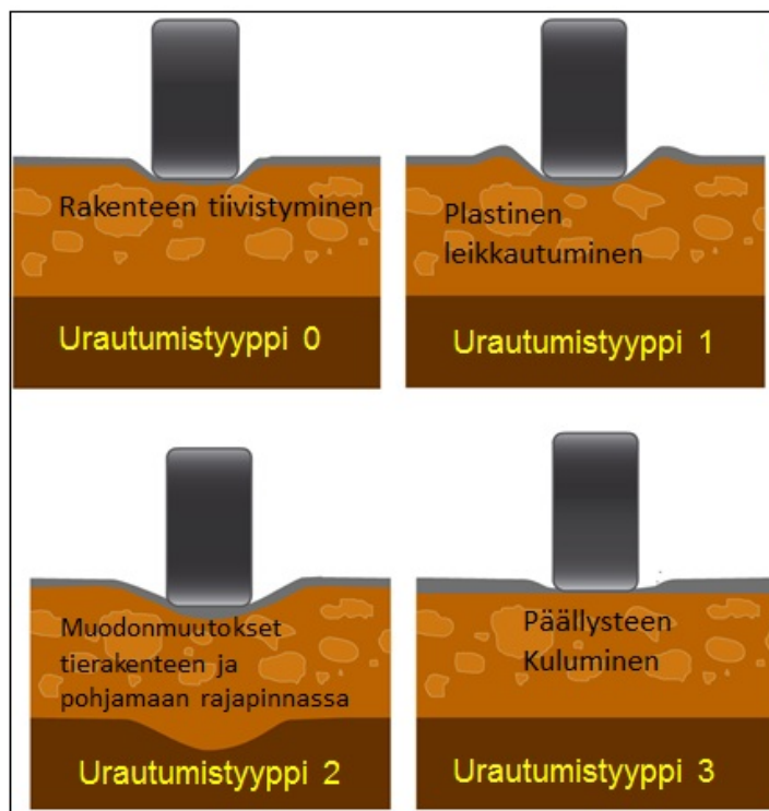
Kuva 2 Urautumistyyppit (Roadscanners Oy 2012, muokattu)
