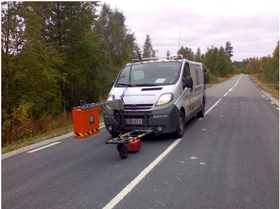
Kuva 4 Roadscanners Oy:n mittausauto, johon on asennettu 1 GHz ilmavasteantenni ja 400 MHz maavasteantenni (Roadscanners 2012)
