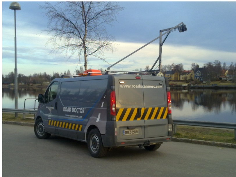
Kuva 10 Mittausauto, johon on kiinnitetty laserskannausjärjestelmä (Kuva: Roadex 2001-2011)
