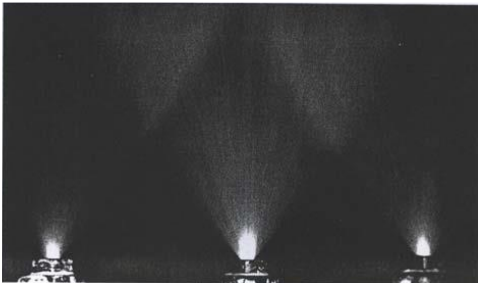
Kuva 4. Pastan suihkutusta spray-päällystyksessä (Tyrväinen 2001)
