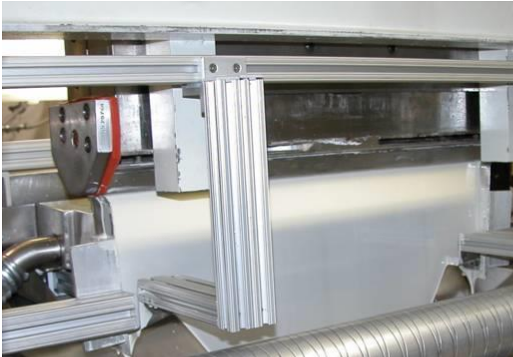
KUVA 3. Verhopäällystysasema (Capella Technology Inc)
