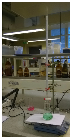
Kuva 4. Liuoksen väri ennen titrausta (vihreä) ja värin muutos ekvivalenttikohdassa (punainen). Titrauksessa käytettävä byretti ja magneettisekoittaja (voi sekoittaa myös käsin).
