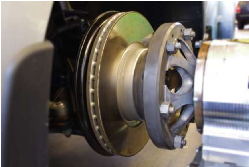
KUVA 1. Dynamometriyksikön kiinnittäminen auton napaan
