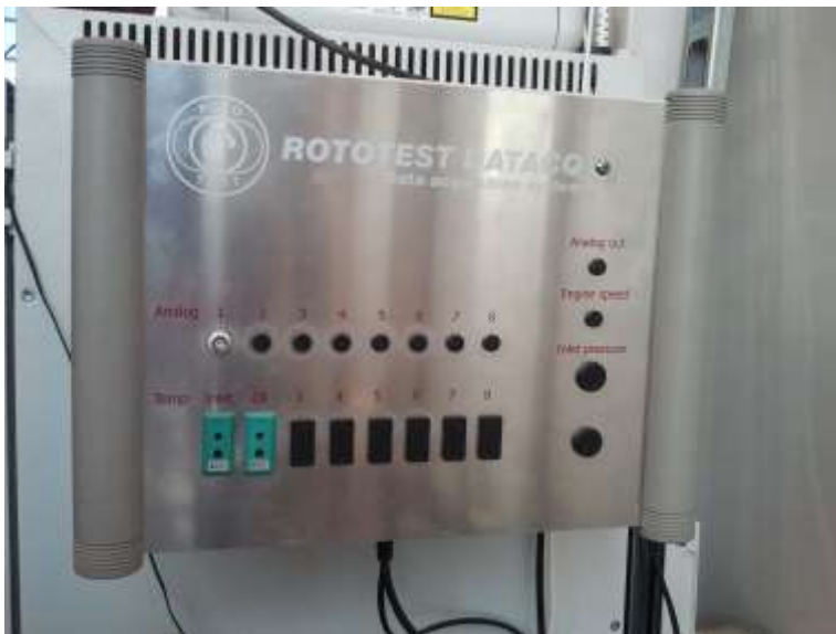
KUVA 5a. Datacq tiedonkeruuyksikkö
