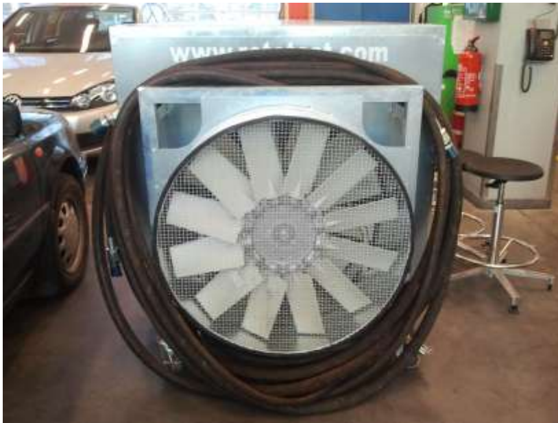
KUVA 3. Hurricane Cooling Unit
