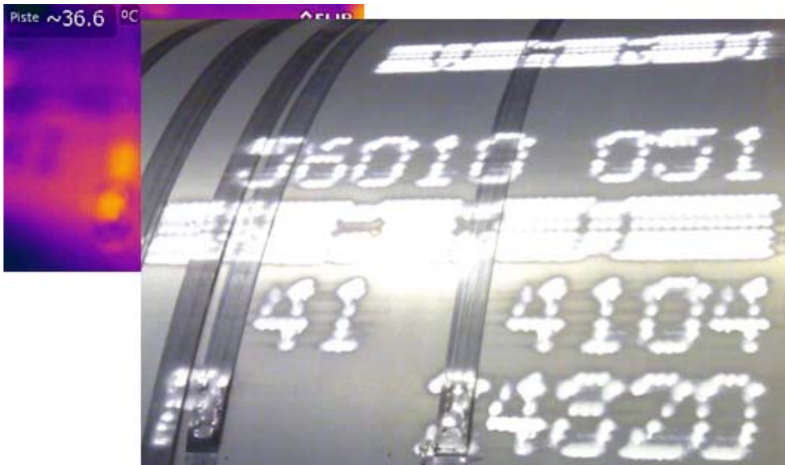
KUVIO 8. Suorakarkaistu kela ja sen lämpötila
