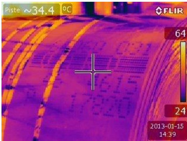
KUVIO 11. Lämpökamerakuva suorakarkaistusta kelasta
