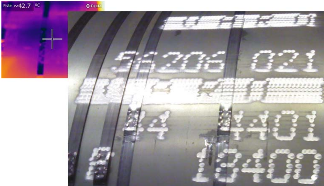
KUVIO 9. Suorakarkaistu kela ja sen lämpötila
