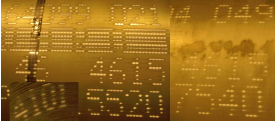
KUVIO 13. Suorakarkaistuille keloille sopiva suuttimien säätöarvo
