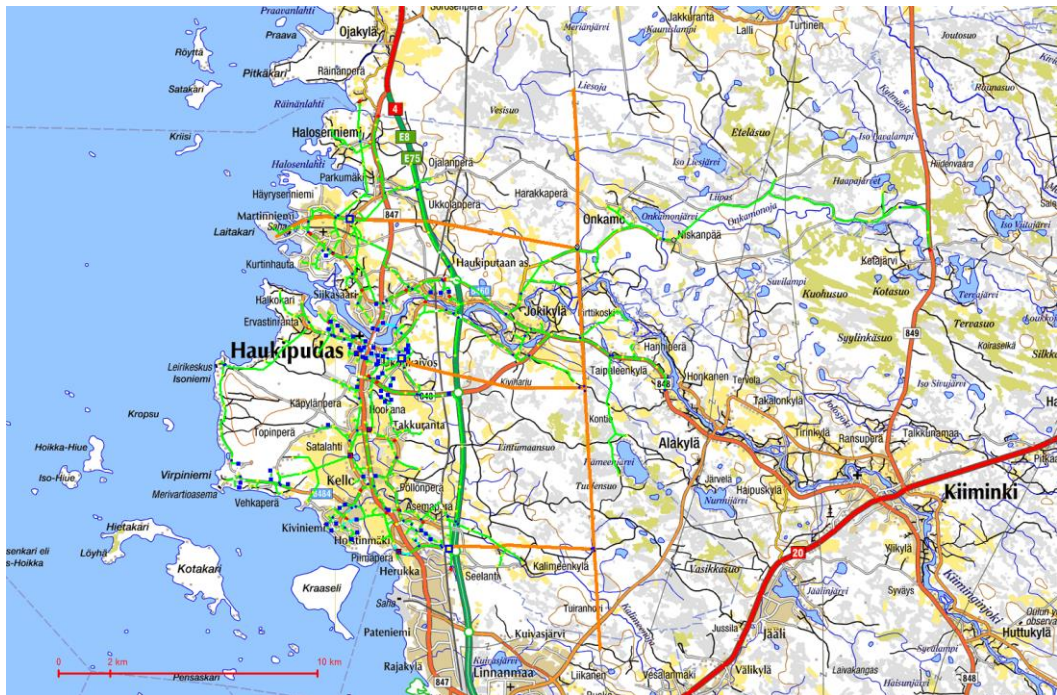
Kuva 4. Haukiputaan Sähköosuuskunnan 110 kV alueverkko ja 20 kV keskijänniteverkko. (DMS 600)
