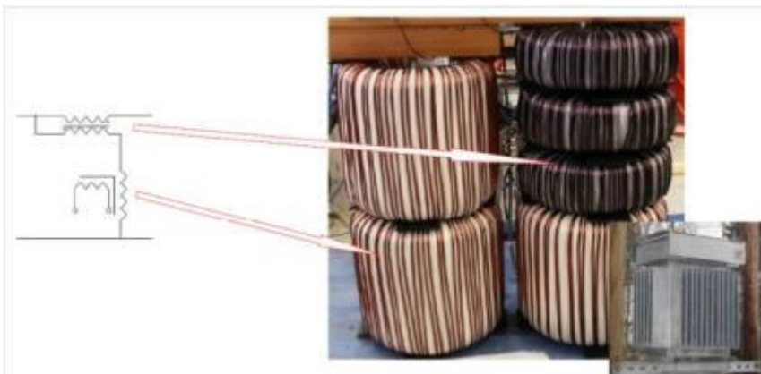
Kuva 62. Jänniteboosterin rakenne. (Tjeldholm, 2012,14)
