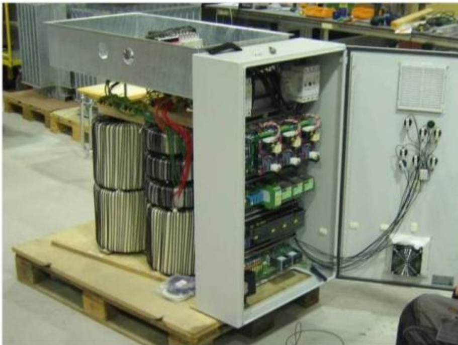
Kuva 53. MVB jänniteboosterin rakenne. (Tjeldholm, 2012,81)
