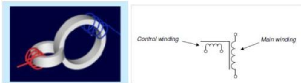
Kuva 54. Induktanssin säätö, ilmaväliä muuttamalla. (Tjeldholm, 2012,8)
