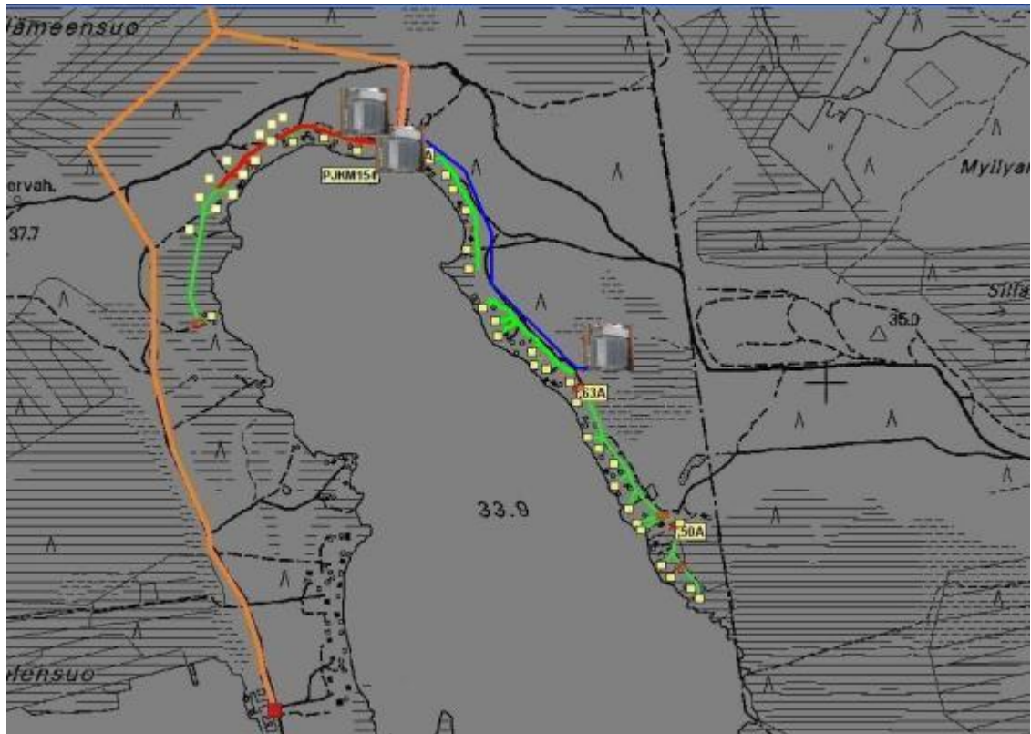
Kuva 100. 1 kV järjestelmän muuntajien sijoitus (DMS 600)
