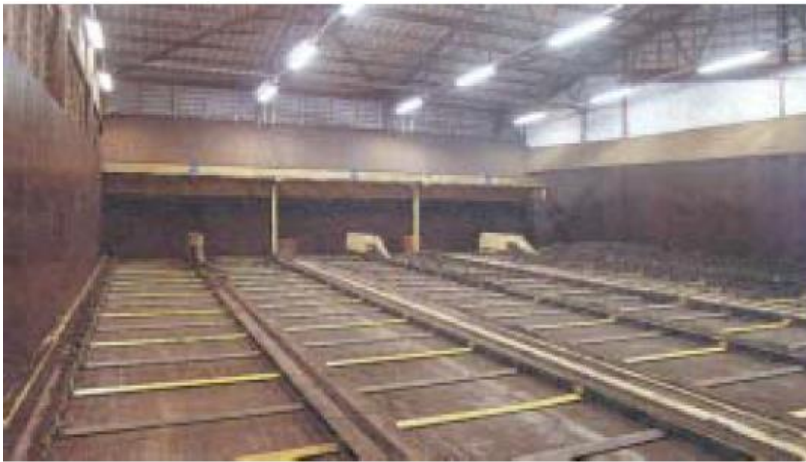
KUVA 2. Kolapohjapurkaimella varustettu vastaanottoasema (3, s. 101)
