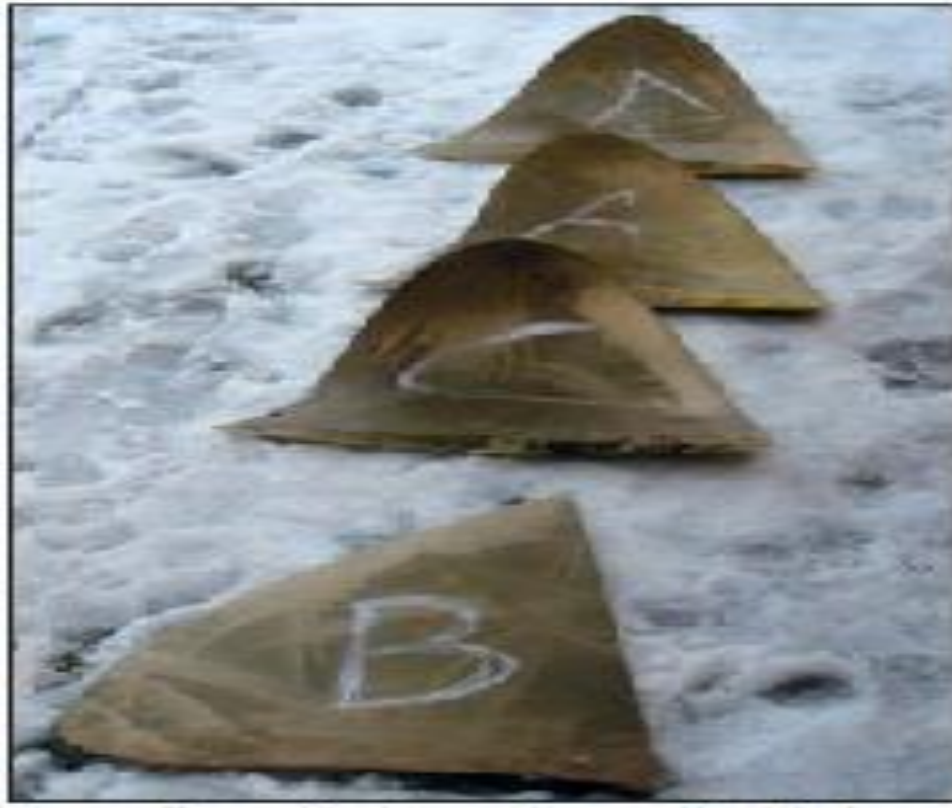
Kuva 7. Vaurioituneen potkurin katkaistut lavat (Hydrex)
