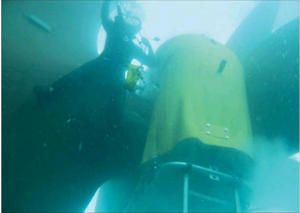
Kuva 9. Habitarepussi potkurin akselin ympärillä (Hydrex)
