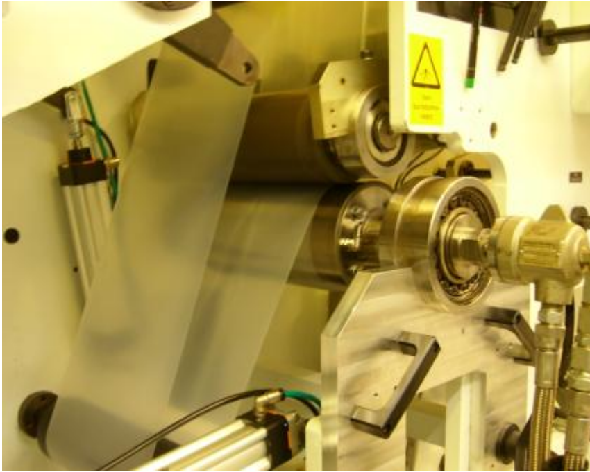
KUVA 14. Picon kuumapuristusyksikkö; ajorata tulee alhaalta kuumapuristusyksikköön, jolloin substraatti esilämpenee ennen puristusta.
