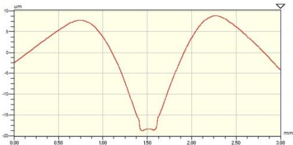
KUVA 15. Sammolla PMMA:lle kuumapuristetun kanavan profiili painopellin lämpötilalla 110 °C
