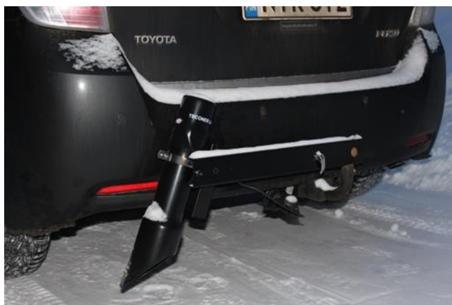
Kuva 2 Ajoneuvon kiinnitettävä optinen kitkamittari (Teconer Oy)
