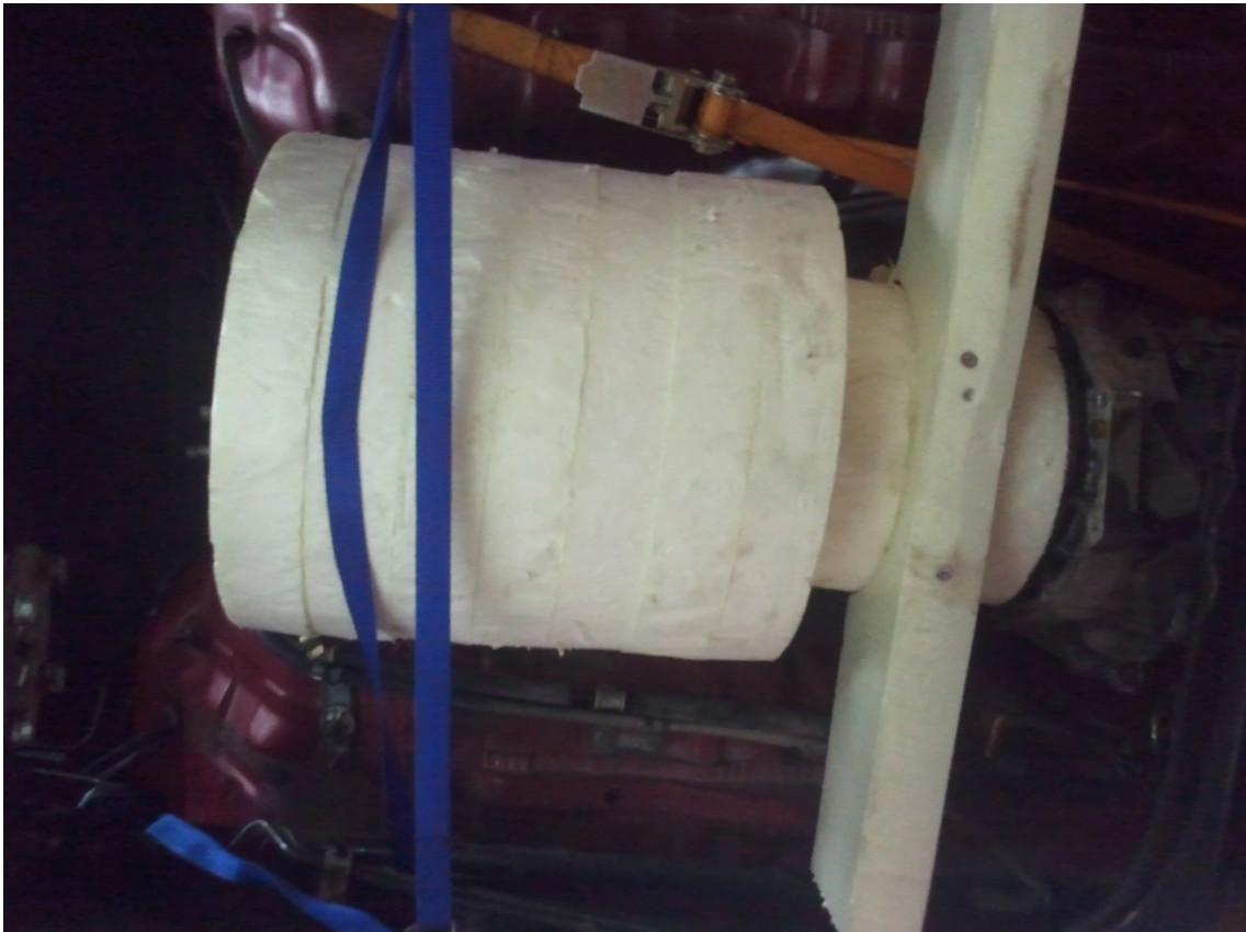
KUVA 7. Polystyreenilevystä valmistettu pikamalli kannakkeesta ja sähkömoottorista
