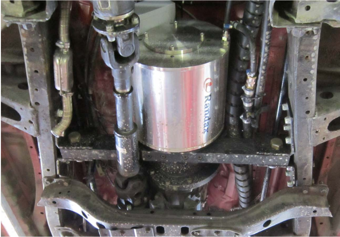
KUVA 30. Moottorikonaisuus asennettuna ajoneuvoon
