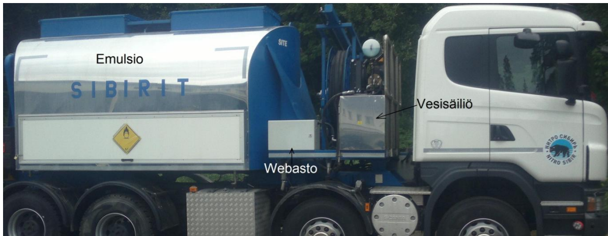
KUVA 5. Webaston laatikko emulsiosäiliön ja vesisäiliön välissä
