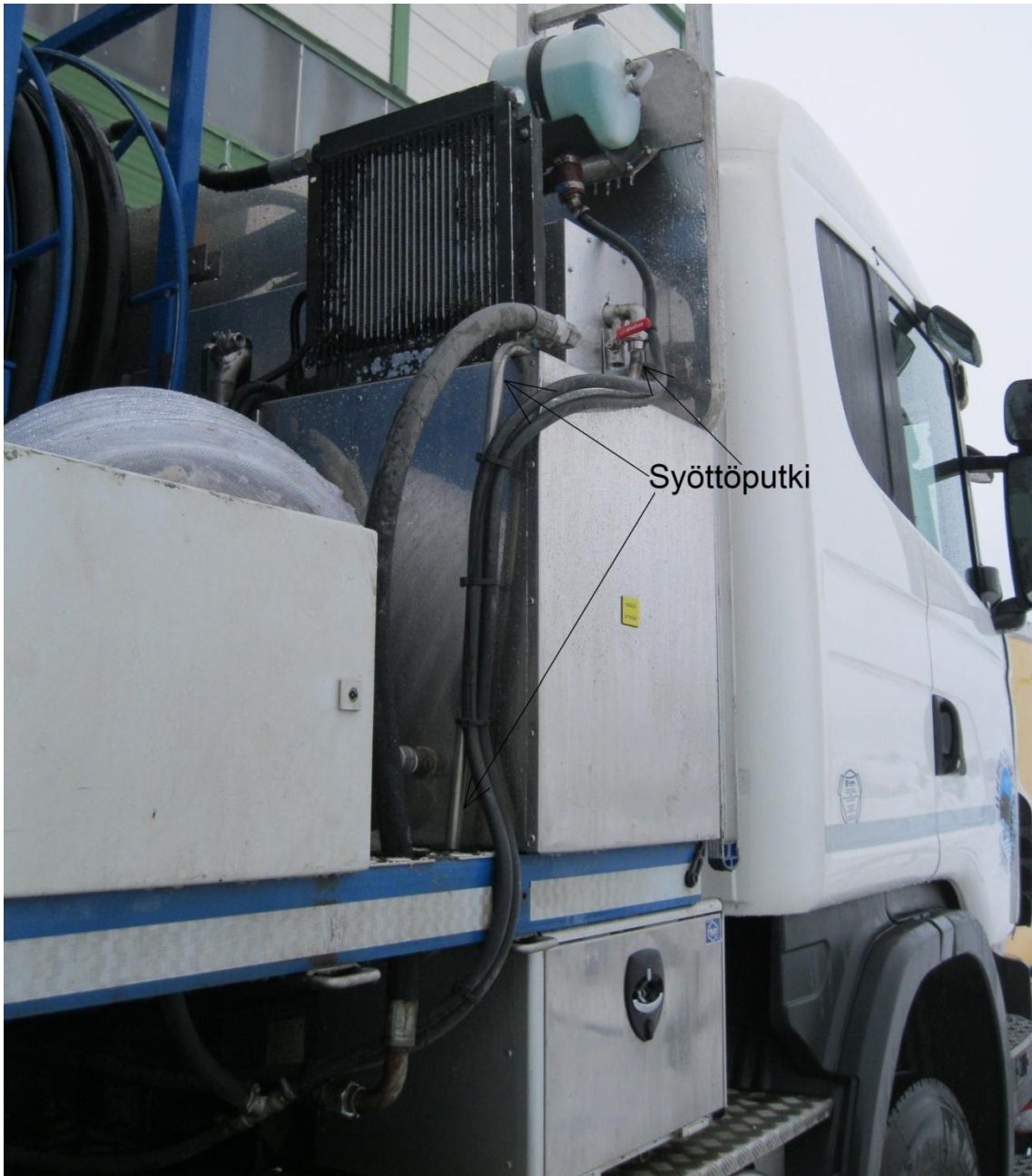
KUVA 11. Veden syöttöputki (auton oikea puoli)
