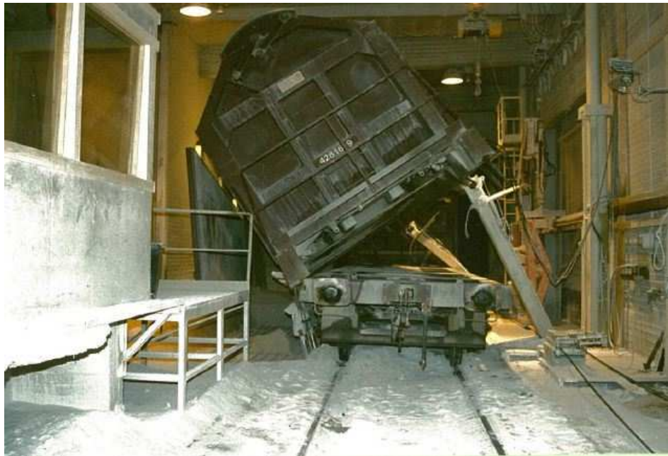
Kuvio 9. Vaunu on livennyt toiselta saranalta, jolloin kallistusvarsien asennot eroavat toisistaan ja toinen varsista on taipunut.
