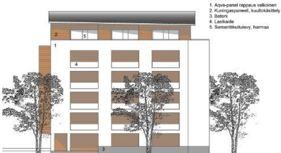
Kuva 3. Julkisivupiirros ja -materiaalit [S]
