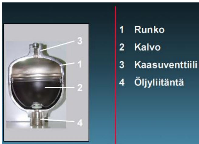
KUVA 9. Kalvoakun rakenne (8)
