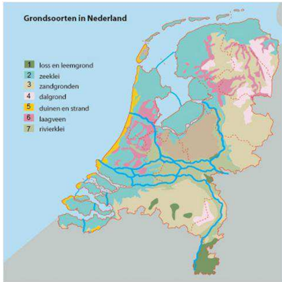
Kuva 2. Alankomaiden maaperä koostuu 1 lössi- ja hiesumaasta, 2 merisavesta, 3 hiekkamaista, 4 kaivetuista turvemaista, 5 dyyni- ja rantamaista, 6 kosteikko- ja turvemaista sekä 7 jokisavesta. (Stichting Deltawerken Online)
