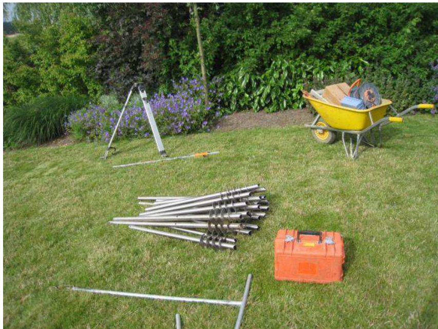
Kuva 19. Kevyempiin rakenteisiin käytettävä käsin kierrettävä ruuviperustus
