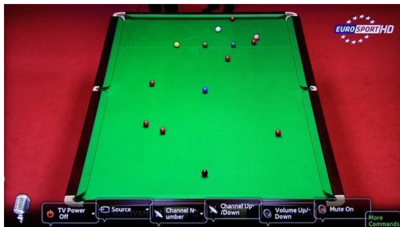
Figur 13. Då man uttalat röststyrningens aktiveringsfras dyker möjliga kommandon upp på skärmen (van Ballegoie 2012).
