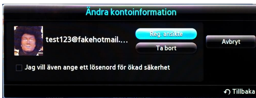
Figur 14. Ansiktsigenkänningsfunktionen sparar en miniatyrbild av en användares ansikte.
