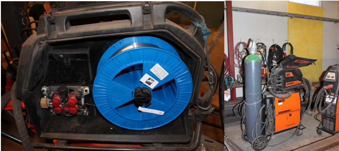
KUVIO 23. Kuva alumiinin hitsaukseen tarvittavista laitteista sekä alumiini lisäainelangasta
