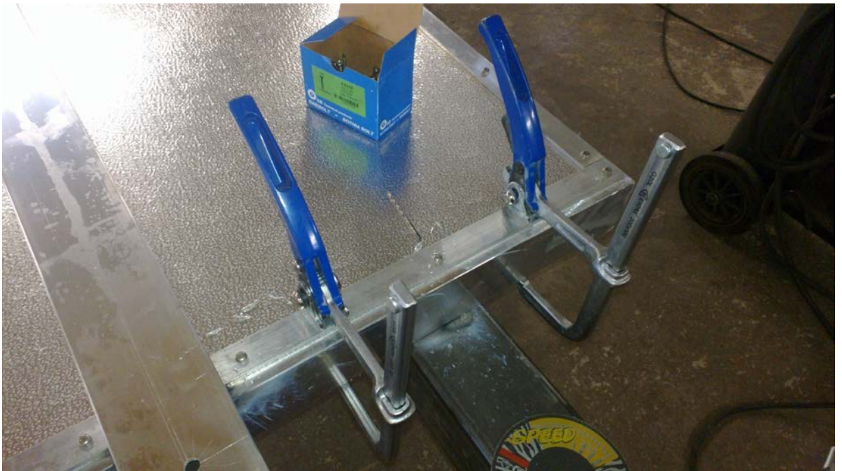
KUVIO 20. Alumiinilevyjen liittäminen aurinkokeräimen runkoon.
