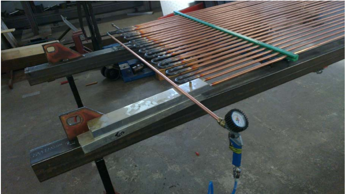
KUVIO 21. Kennoston koeponnistus ja muovikiinnikkeet.
