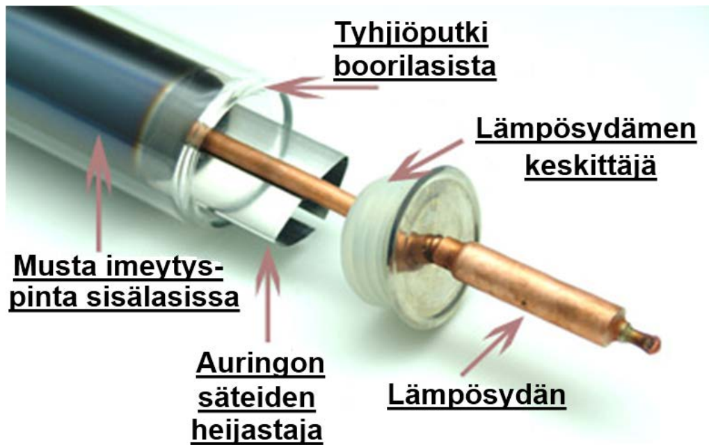
KUVIO 6. Tyhjiöputkikeräimen rakenne.
