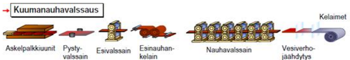
KUVA 1. Nauhavalssaausprosessi (Jortama 2012, sähköpostiviesti)
