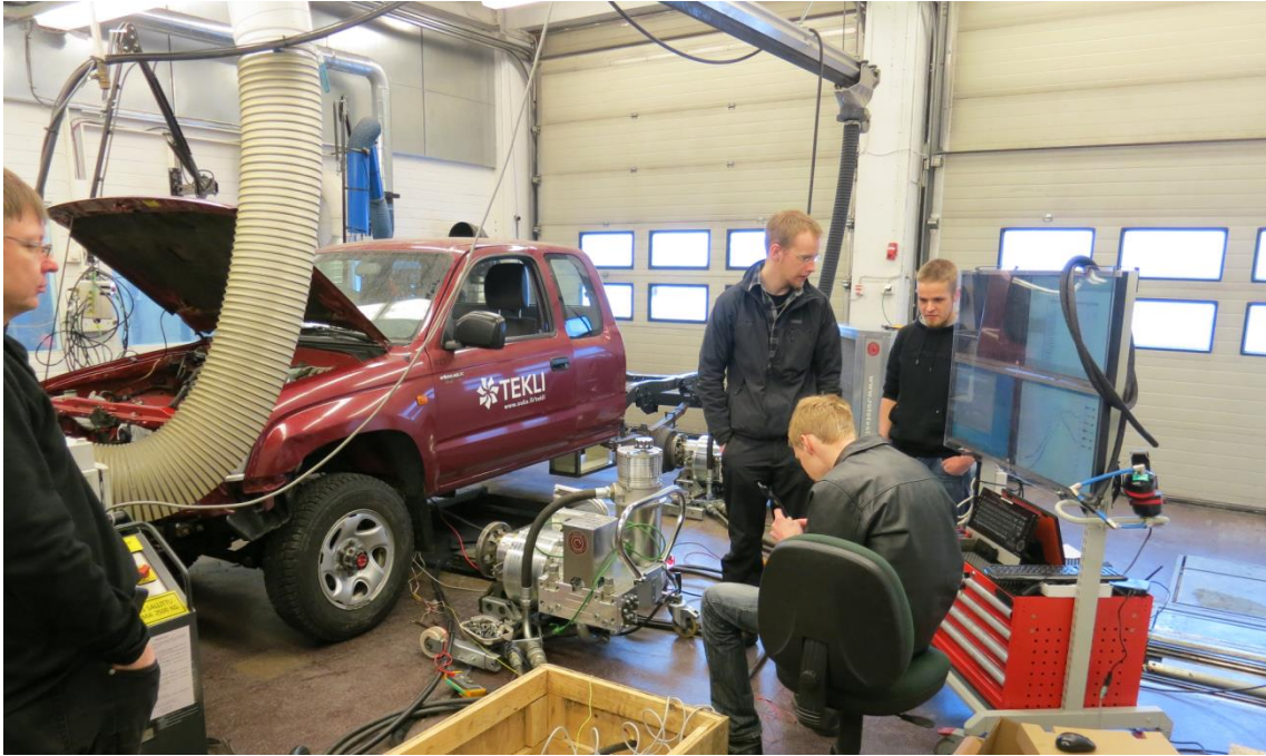
KUVA 1. Sähkömoottorilla varustetun Hiluxin ensimmäinen dynamometrimittaus 19.4.2012
