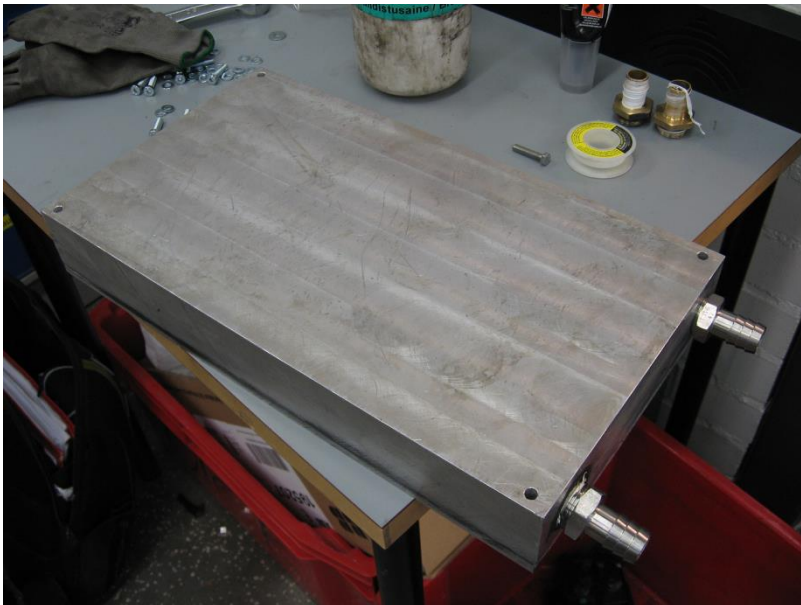
KUVA 2. Alumiinista valmistettu cold plate -jäähdytyslevy taajuusmuuttajalle
