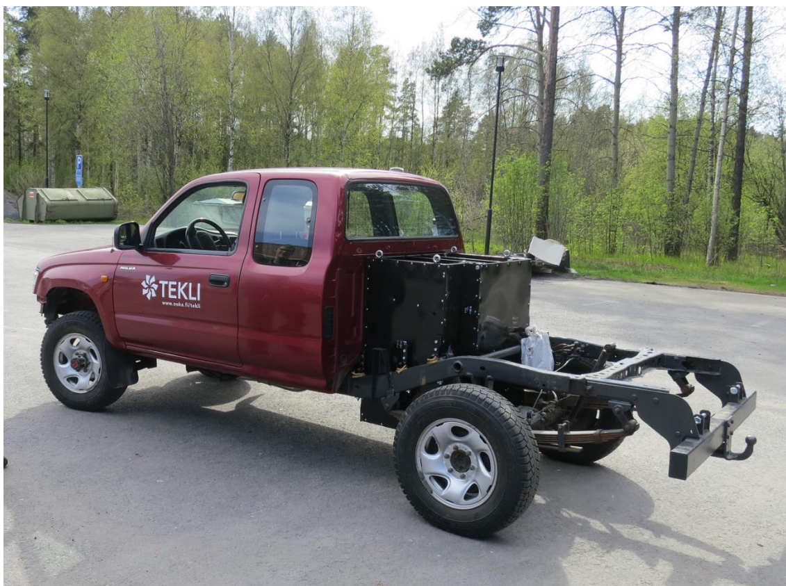
KUVA 3. Hilux-sähkötyökoneen ensimmäinen testiajo sähkökäyttöisenä 25.5.2012
