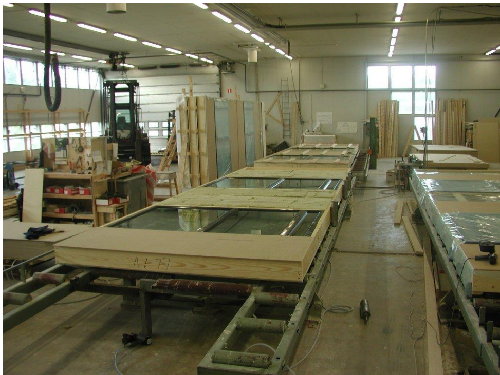
KUVA 2. PPE Palkki oy:n tuotantotilat; ulkoseinäelementtejä kääntöpöydillä (Kruunu 2013.)
