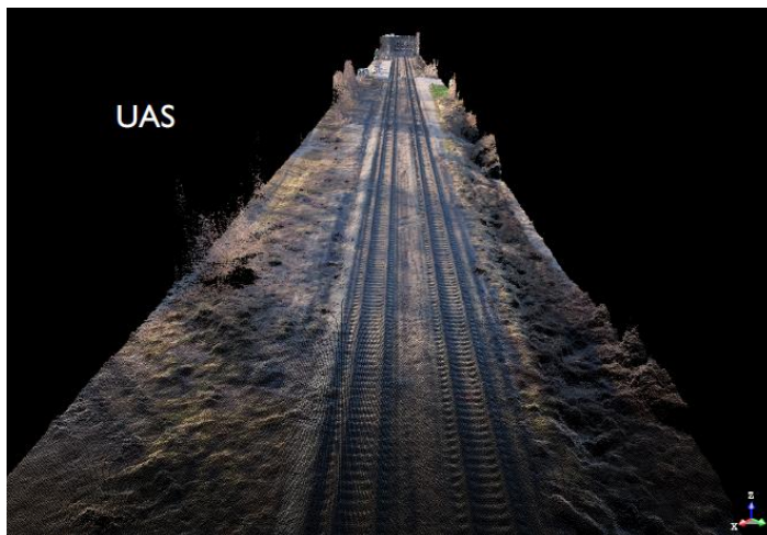
Kuva 11. UAS-mittausmenetelmällä tuotettu lähtötietomalli. (33.)
