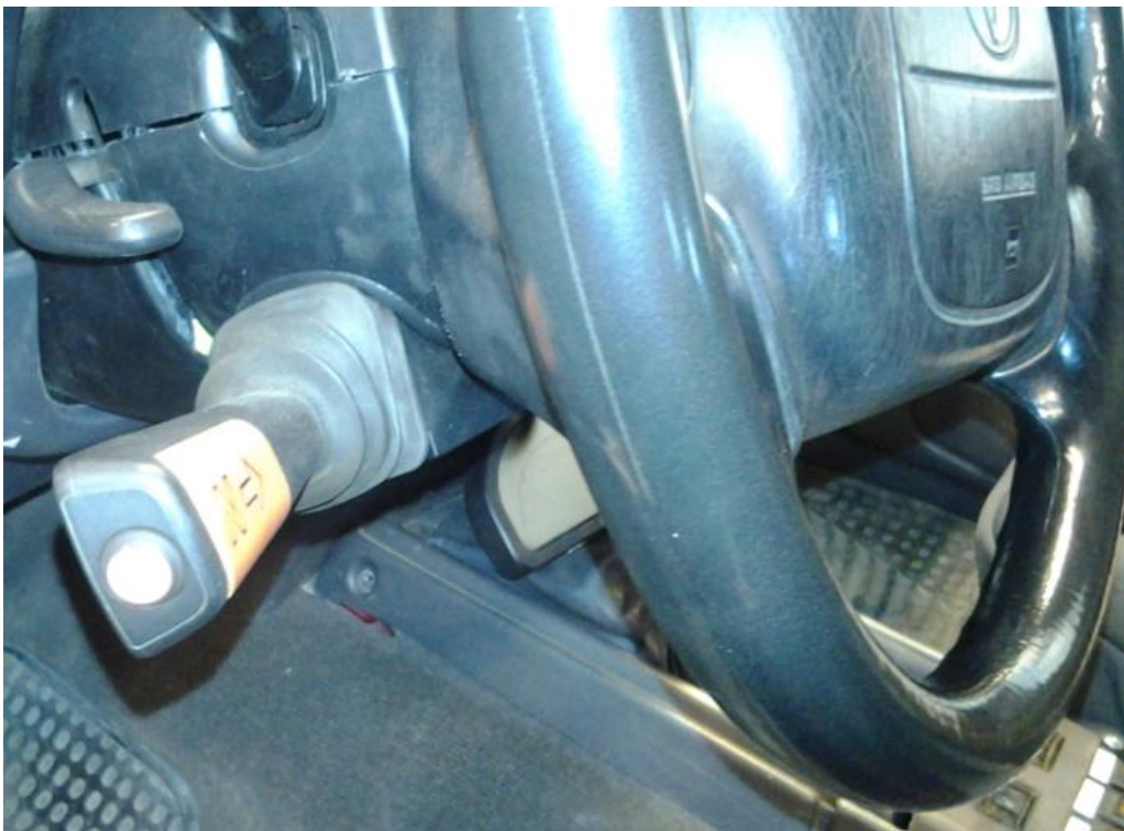
KUVA 11. Suunnanvaihtokytkin sijoitettuna ohjauspylvääseen.
