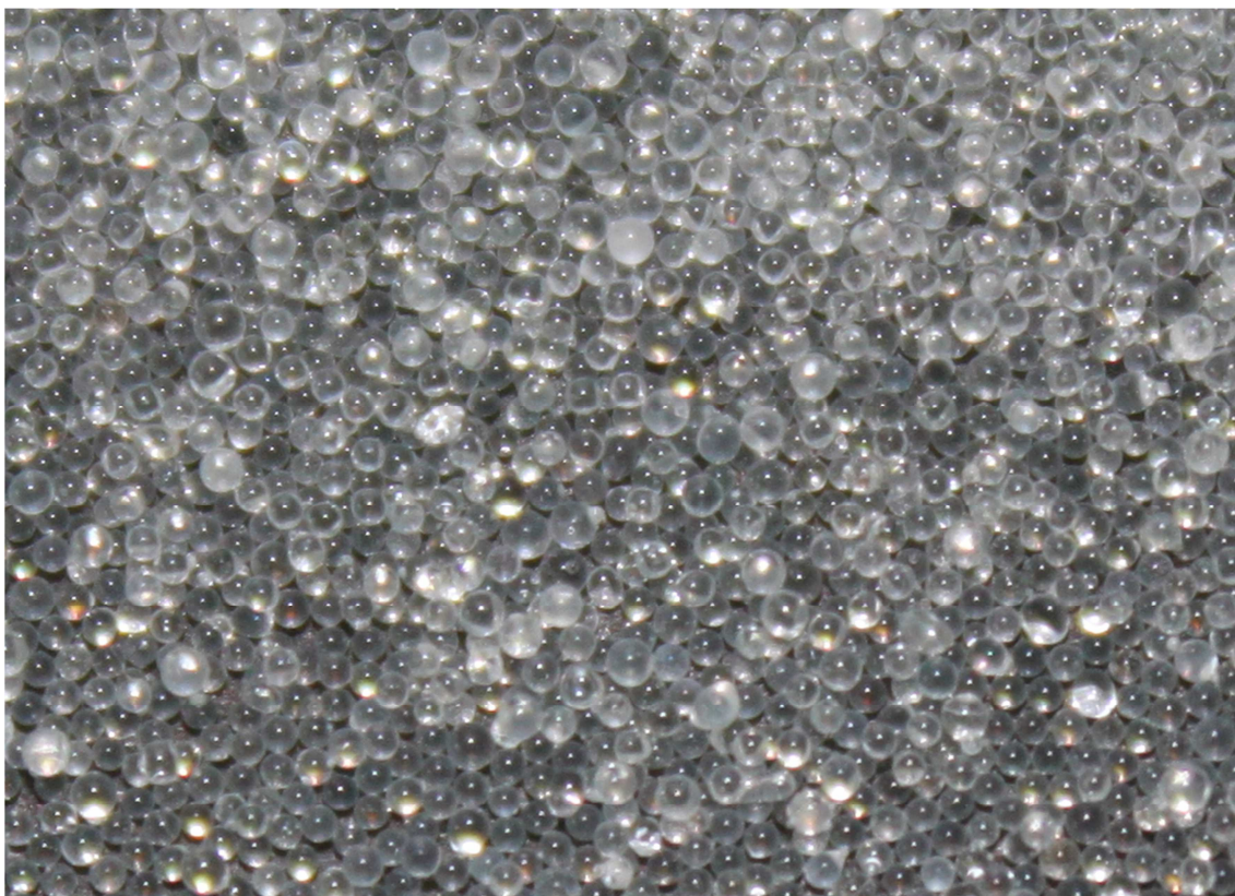
Kuva 11. Työssä tutkittuja lasihelmiä kooltaan 0,4 mm. Kuva on suurennus.
