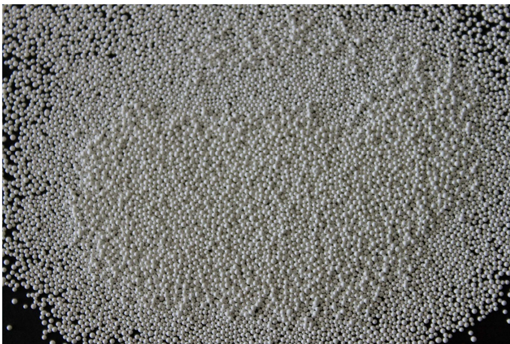
Kuva 10. Suurennettu kuva työssä tutkituista zirkoniumhelmistä. Helmikoko 0,4 – 0,6 mm
