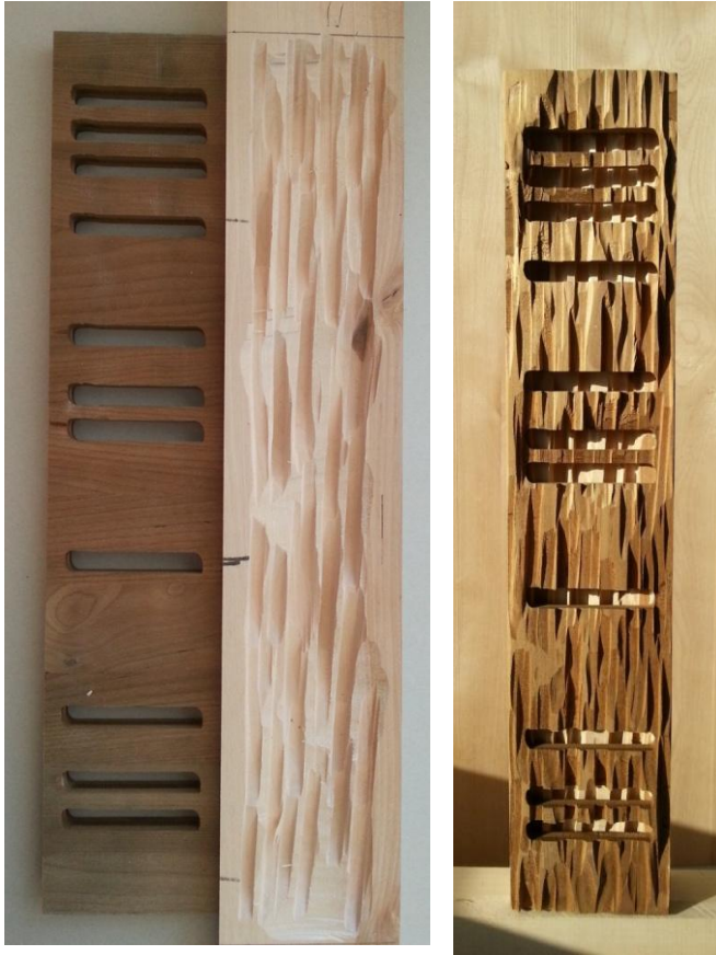
Kuva 15. Vesileikkurilla leikattu muoto liimattuna koivulankkuun, johon ennalta sahalaikalla työstetty yhdensuuntaisia veistouria.
