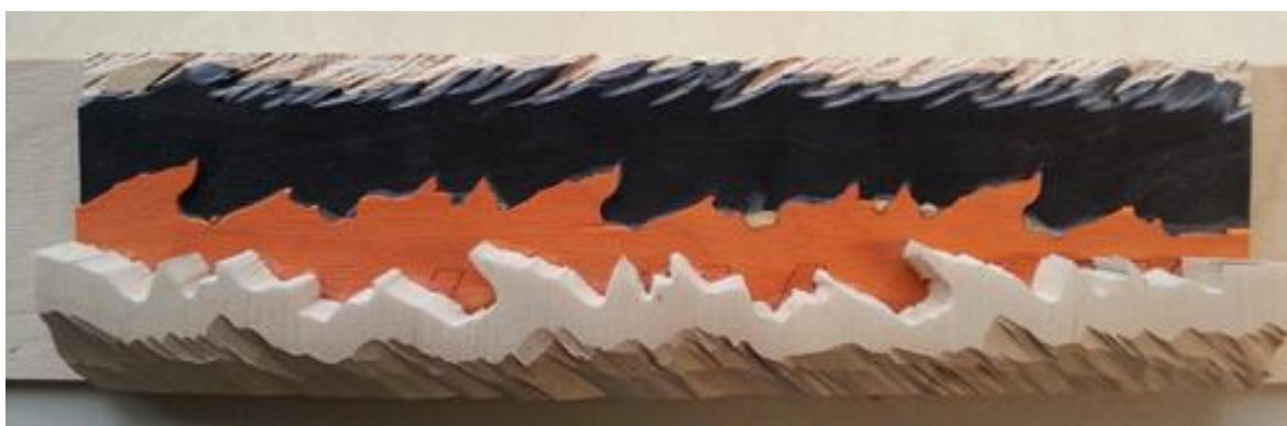
Kuva 7. Kuvan 6 tapaan tässä on yhdistetty viilua ja paksumpaa puuta sahalaikalla työstettynä.
