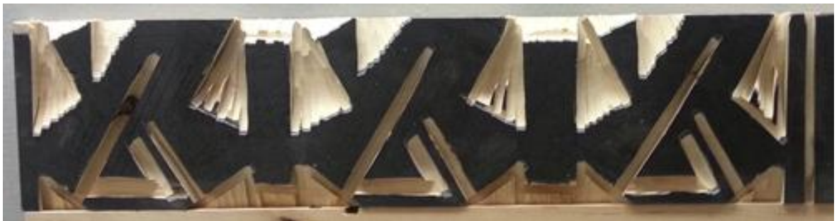
Kuva 2. Viilutettuun puuhun laserkuvioitu arabiakuosi, sahalaikalla veistettynä.
