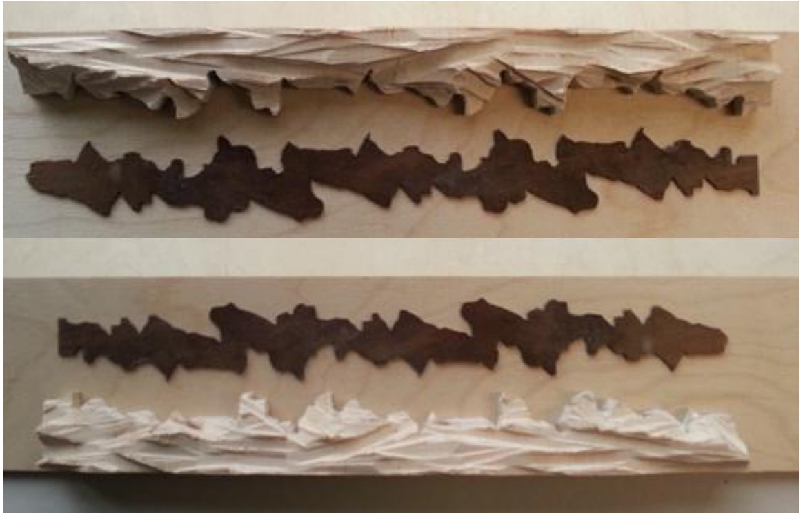
Kuva 5. Vesileikkurilla muotoon leikattu koivulankku työstetty sahalaikalla pituussuuntaan ja laserilla leikattu ruskea viilu sommiteltuna.
