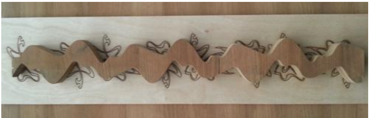
Kuva 13. Vesileikkurilla leikattu muoto koesommiteltuna vanerille, joissa erilaisia laserilla piirrettyjä koristekuvioita.
