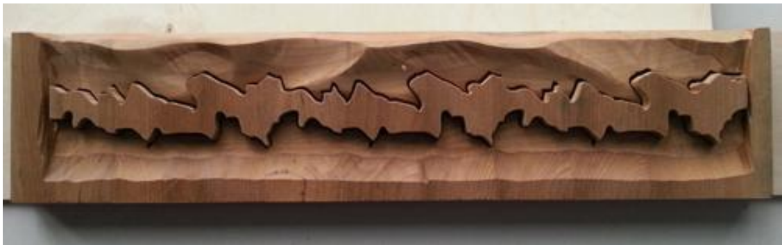
Kuva 8. Vesileikkurilla leikattu muoto on irrotettu kahteen osaan ja taustan liimattu vaneeriin, jotta pystyin työstämään sitä sahalaikalla
