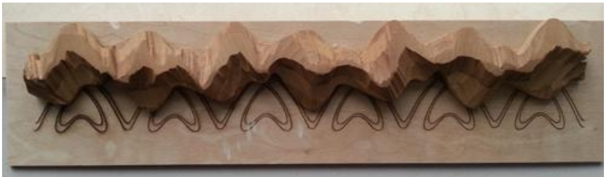
Kuva 12. Vesileikkurilla leikattu muoto liimattuna vanerille, jossa laserilla piirretty koristekuvio. Taustakuvio (Liite 10.)
