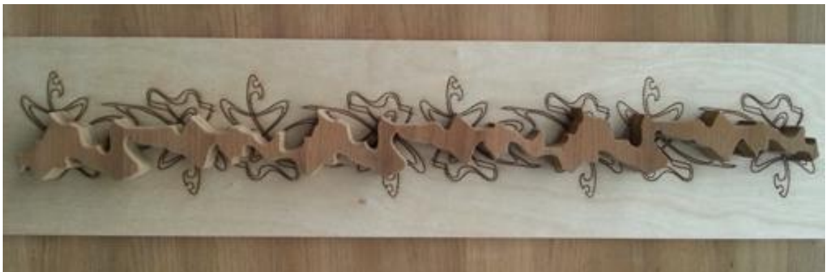
Kuva 14. Vesileikkurilla leikattu muoto koesommiteltuna vanerille, joissa erilaisia laserilla piirrettyjä koristekuvioita. Taustakuvio (Liite 10 ja 11.)
