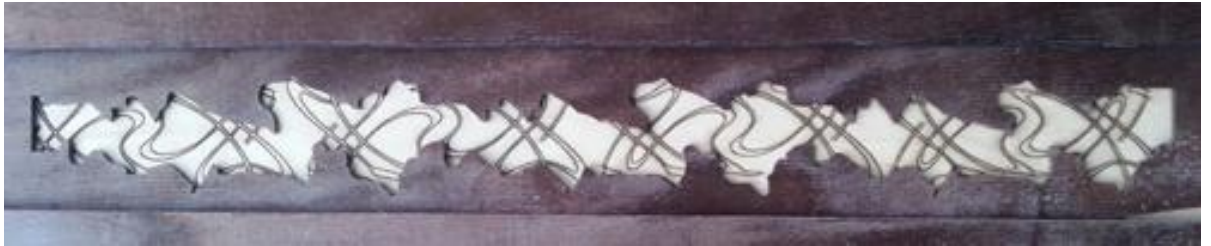
Kuva 18. Laserilla läpileikattuja viiluja sommiteltu laserin piirtojaljen päälle. Yllätyksellinen ja siksi potentiaalinen jatkokehittelyä ajatellen. (Ryhmä 6. intarsia) Taustakuvio (Liite 10 ja 11.)
