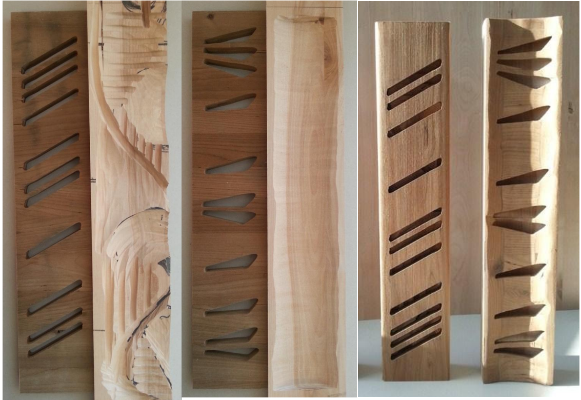
Kuva 10. Vesileikkurilla leikattu muoto liimattuna koivulankkuun, joihin ennalta sahalaukalla työstyetty erilaisia syvennyksiä.
