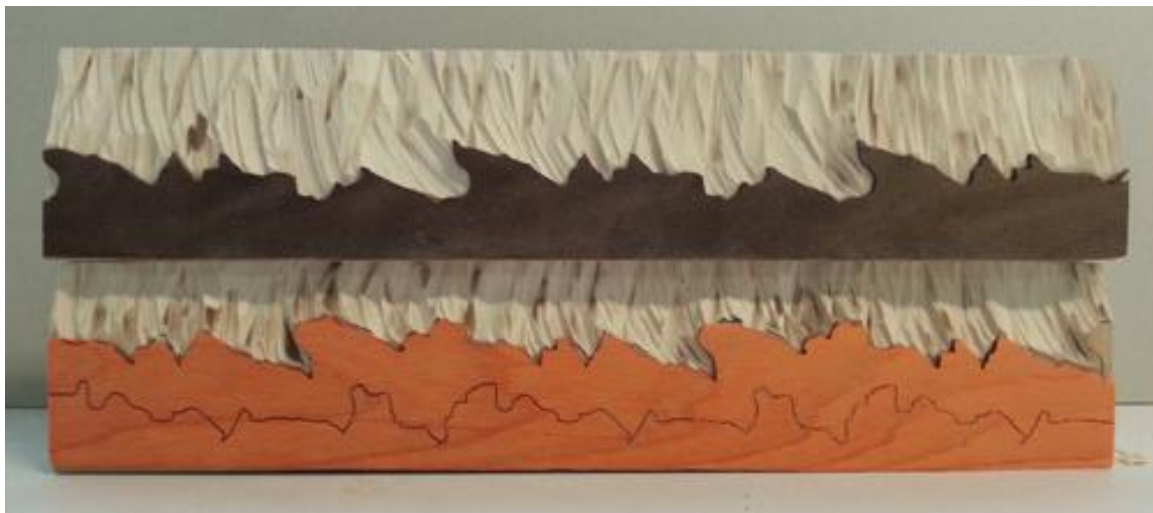
Kuva 4. Laserilla leikattu viilu liimattuna sahalaikalla työstettyyn koivulankkuun. (Ryhmä 1. Pintakontrasti)
