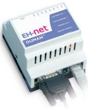
KUVA 8. EH-net palvelin (Modbus-600 asennus- ja kytkentäohje 2006)
