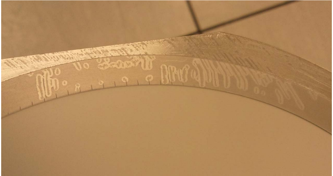
Kuva 11. Teipin alle jäänyt vanha liima aiheuttaa kuplan, josta teippi ei kiinnity teippikehykseen.
