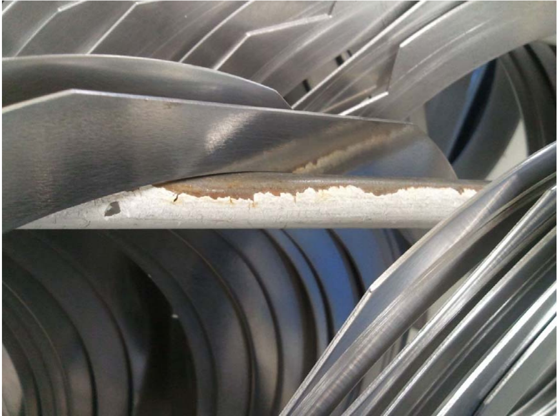
Kuva 15. Teippikehukset kolhiintuneella ja ruostuneella kuivatusorrella.
