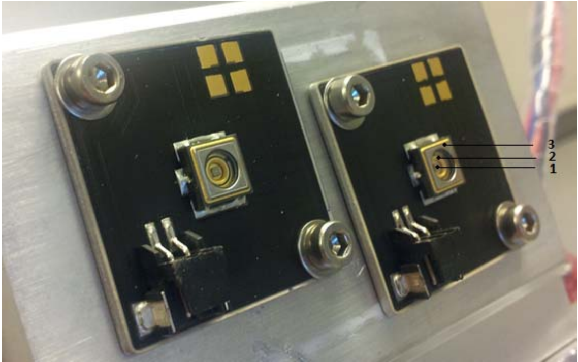
Kuva 26. Nichia NCSU033APE Engineering samples juotettuna alumiiniseen piirilevyyn ja kiinnitettynä alumiiniseen jäähdytysrivastoon.
