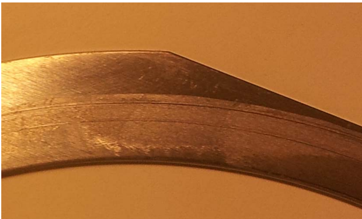
Kuva 34. Valotetun ja valottamattoman alueen liiman siirtyminen UV-850 T-teipistä teippikehykselle ja niiden välinen terävä rajapinta.
