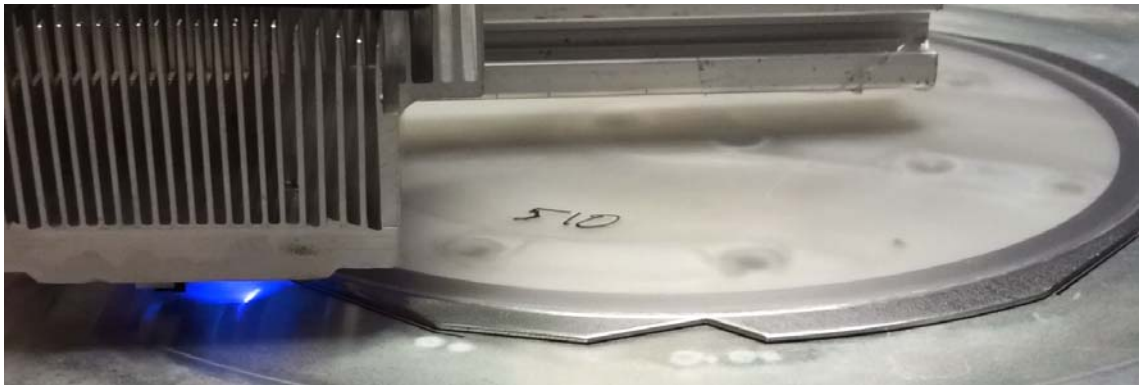
Kuva 29. Valotuskoe NCSU033A-ledillä ja Adwill UV-510 -teipillä. Kuvassa näkyy myös ledin tuottama sininen valo.
