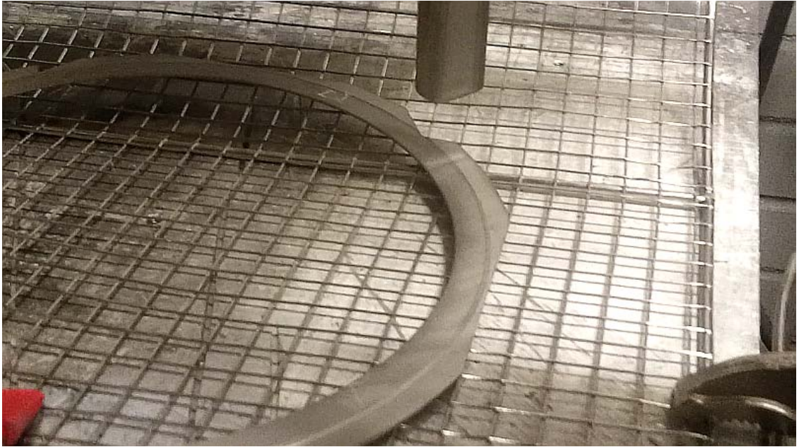
Kuva 18. Kuivajääpuhallus Cold Jet i3 Micro Clean -laitteella.
