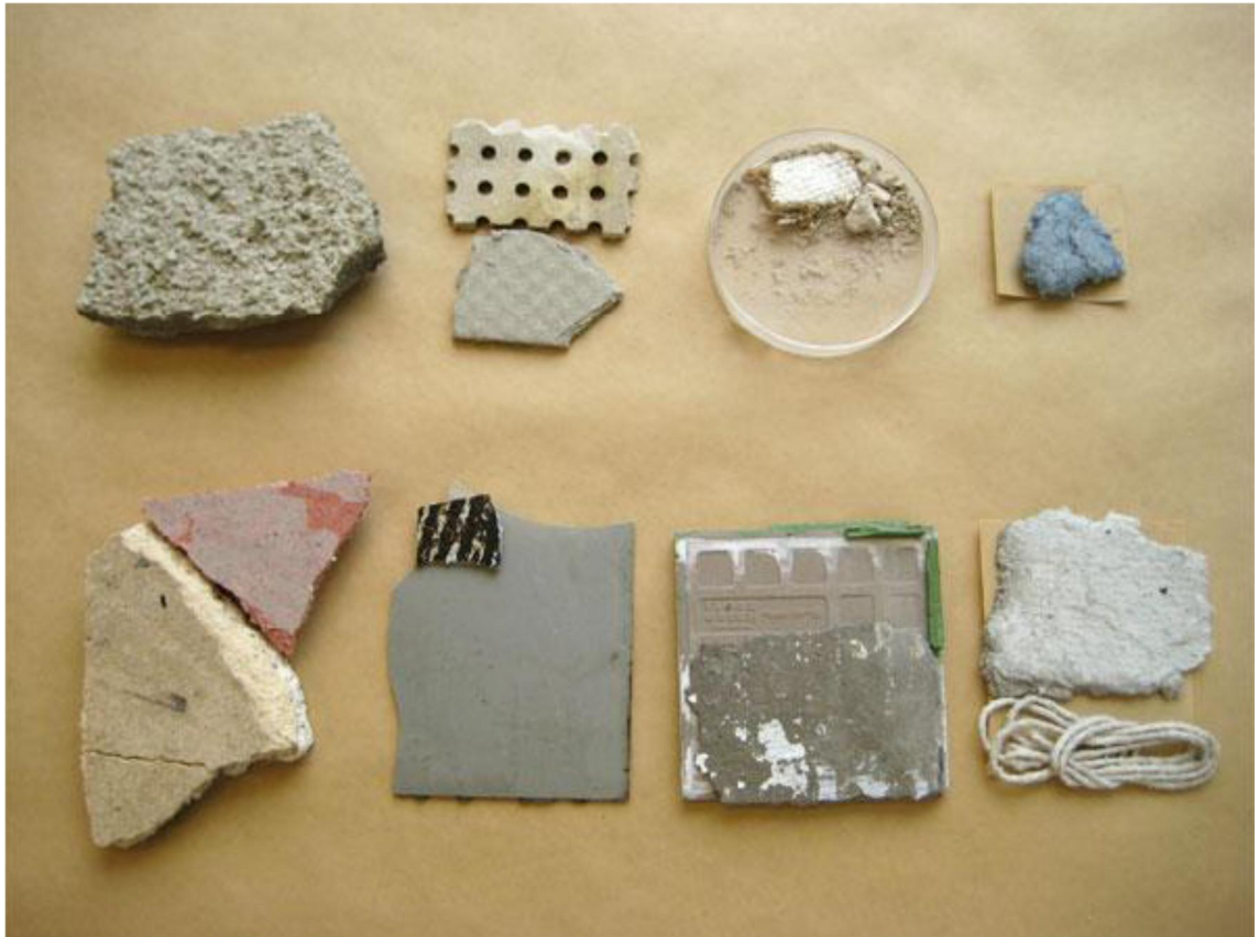
Kuva 5. Asbestipitoisia rakennusmateriaaleja (Oksa, Korhonen ym. 2011)
