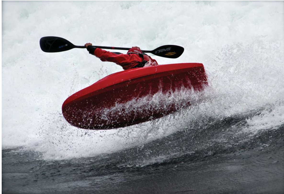
Kuva 8 Pohjan jyrkästi nousevat päädyt auttava melojaa kääntämään aallon liike-energiaa ilmaviksi liikkeiksi.
