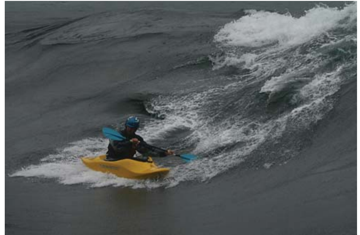
Kuva 7 Pohjan muoto nostaa kajakin plaaniin, jolloin se liukuu aallon päällä pienellä kitkalla tasaisen pohjansa päällä.
