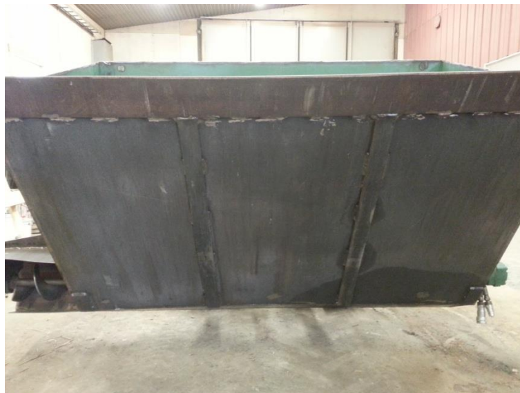
Kuva 4. Kuvassa näkyvät kauhan pohjan vahvikeraudat ja yläreunassa oleva huulilevy.
