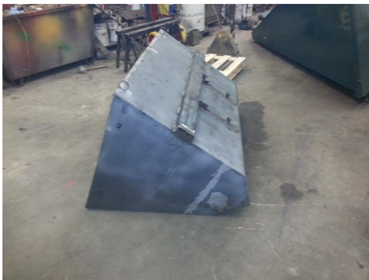
Kuva 2. Kuvassa kauhan takaseinämän rakenne.
