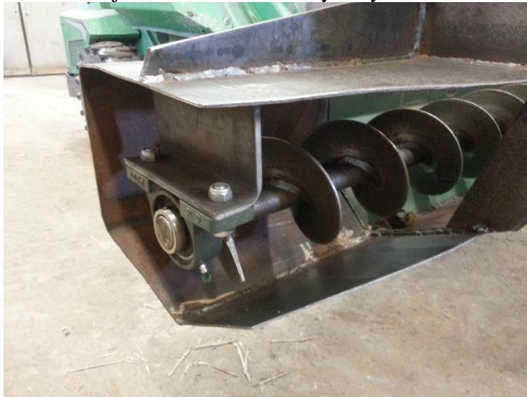
Kuva 7. Kuvassa näkyy kairan loppupään kiinnitys ja laakerointi.
