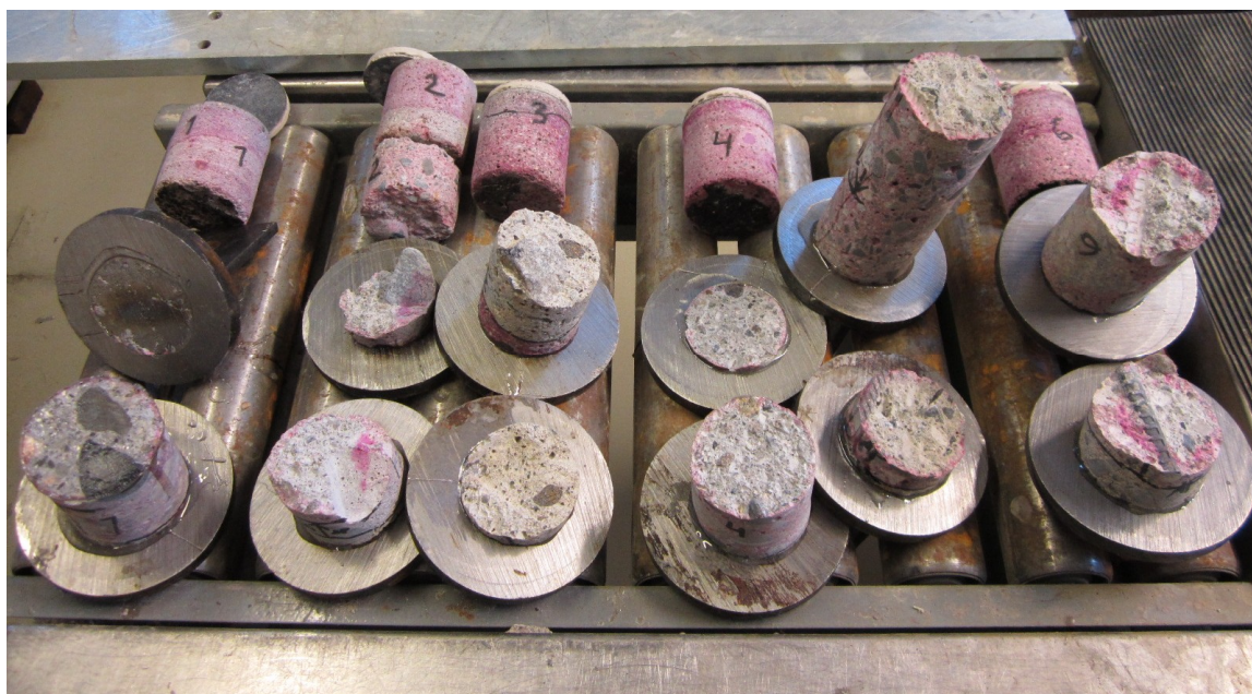
Kuva 2. Vetolujuustestaukset on tehty. Näytteen 2 murtopinnassa on isohko kivi, joka kattaa noin ¼ osan murtopinnasta. Näytteen 3 murtopinnassa oleva kivi on noin ½ poikkileikkauksen pinta-alasta. Näytteen 5 reunassa on teräksen osa ja näytteen 6 murtopinnassa Ø 10 mm harjateräs. Teräksissä ei havaittu ruostetta.
