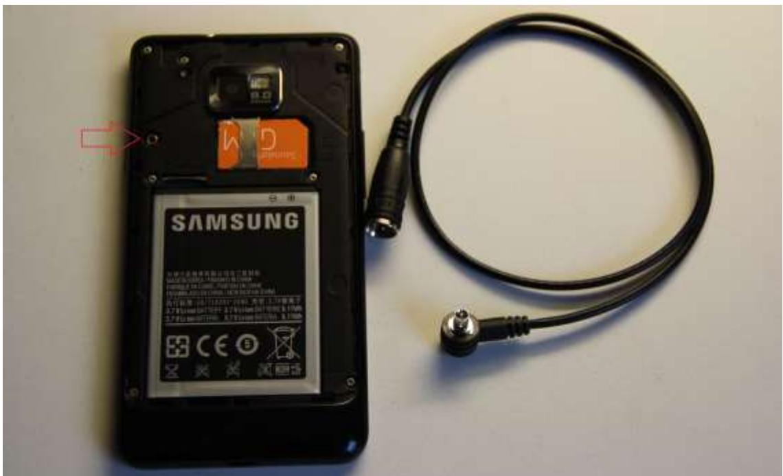
Kuva 10. Samsung Galaxy S2-antenniliitin ja antennijohto.
