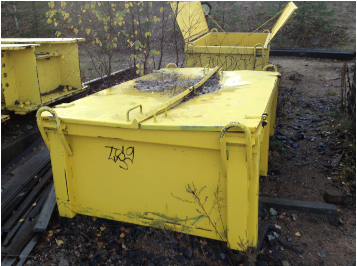
KUVA 8. Varustelaatikon vuotava kansi
