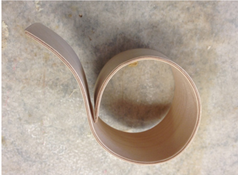
Kuva 15. Mahdollisimman pienen taivutussäteen taivutuskokeilu kahden millin paksuisella vanerilla.
