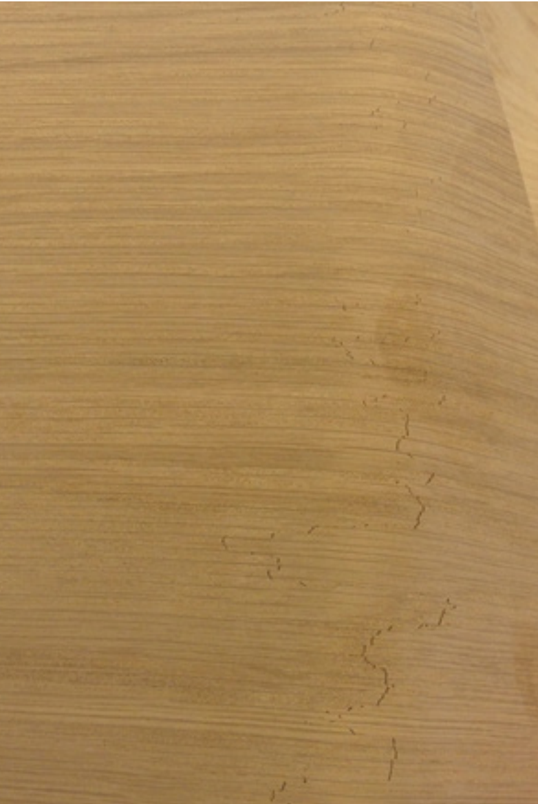
Kuva 2. Tammiviilu taivutuksen jälkeen.
