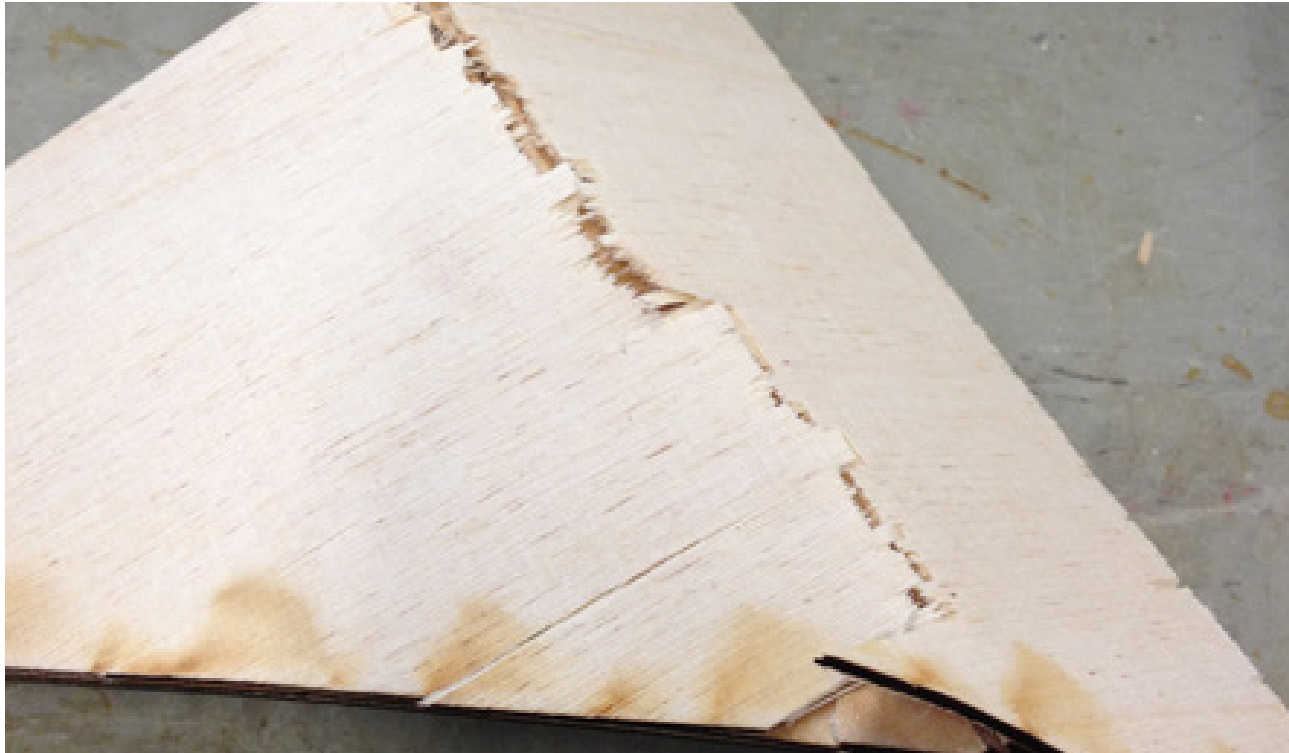
Kuva 1. Liimakalvo ei ole sulanut oikein.
