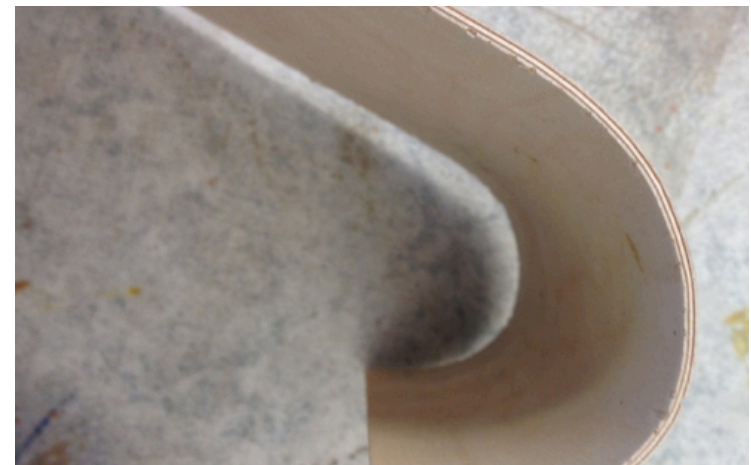
Kuva 13. Vain osa levyistä lämmitetty ja taivutettu.
