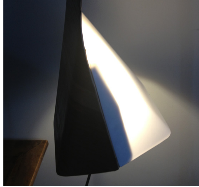
Kuva 33. Saumalista näkyy akryylista läpi.
