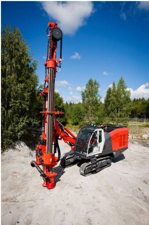
KUVA 2. Sandvik DI550. Alakotelo sijaitsee pystyssä olevassa syöttölaitteessa noin hytin korkeudella. Kuvassa on nykyinen alakotelo (Sandvik kuvapankki).
