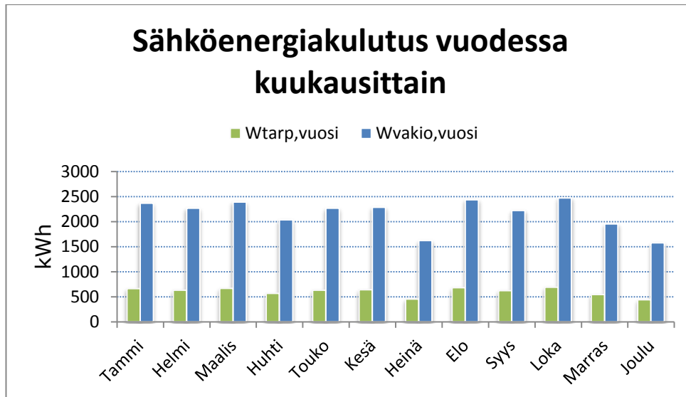
Kuvio 11. Ilmanvaihtokoneiden vuosittainen sähköenergiakulutus.
