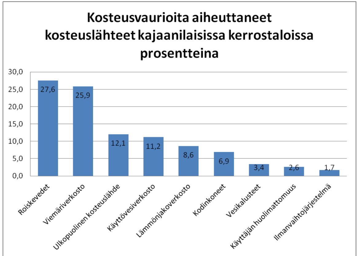
Kuva 3. Kosteusvaurioita aiheuttaneet kosteuslähteet kajaanilaisissa kerrostaloissa
