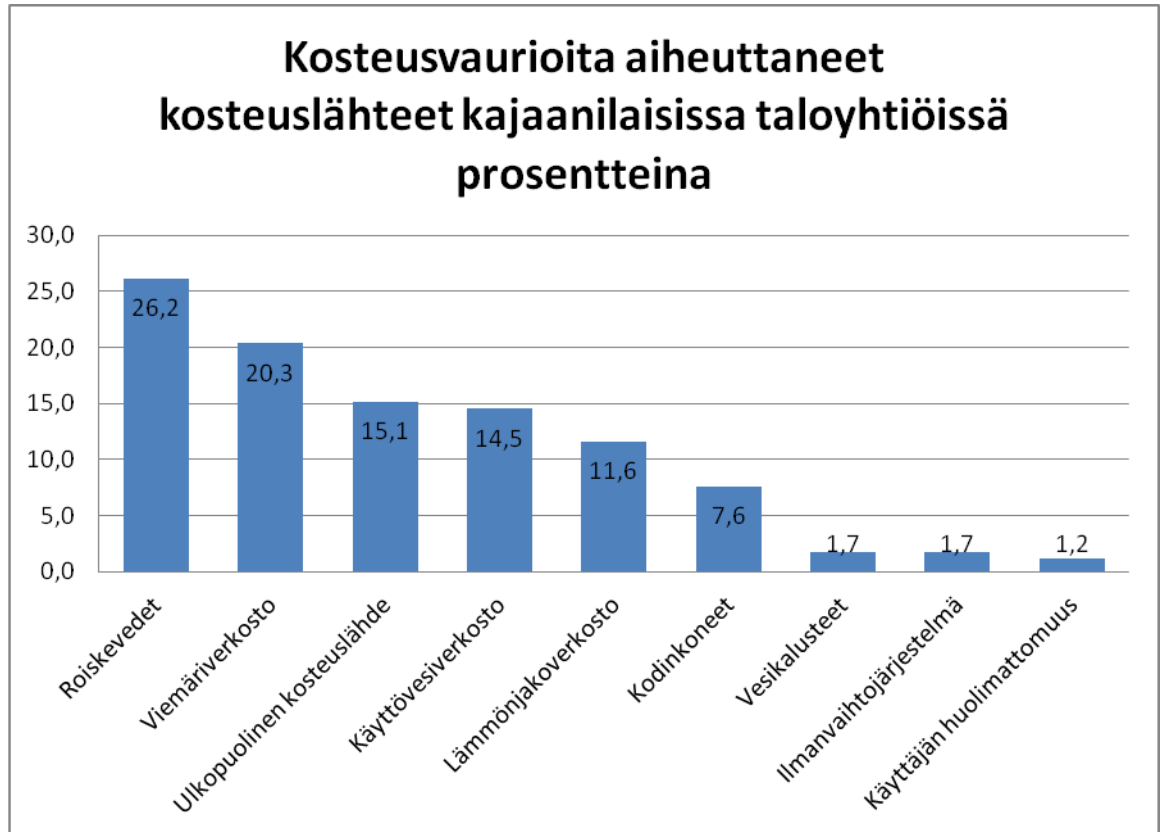
Kuva 1. Kosteusvaurioita aiheuttaneet kosteuslähteet kajaanilaisissa taloyhtiöissä
