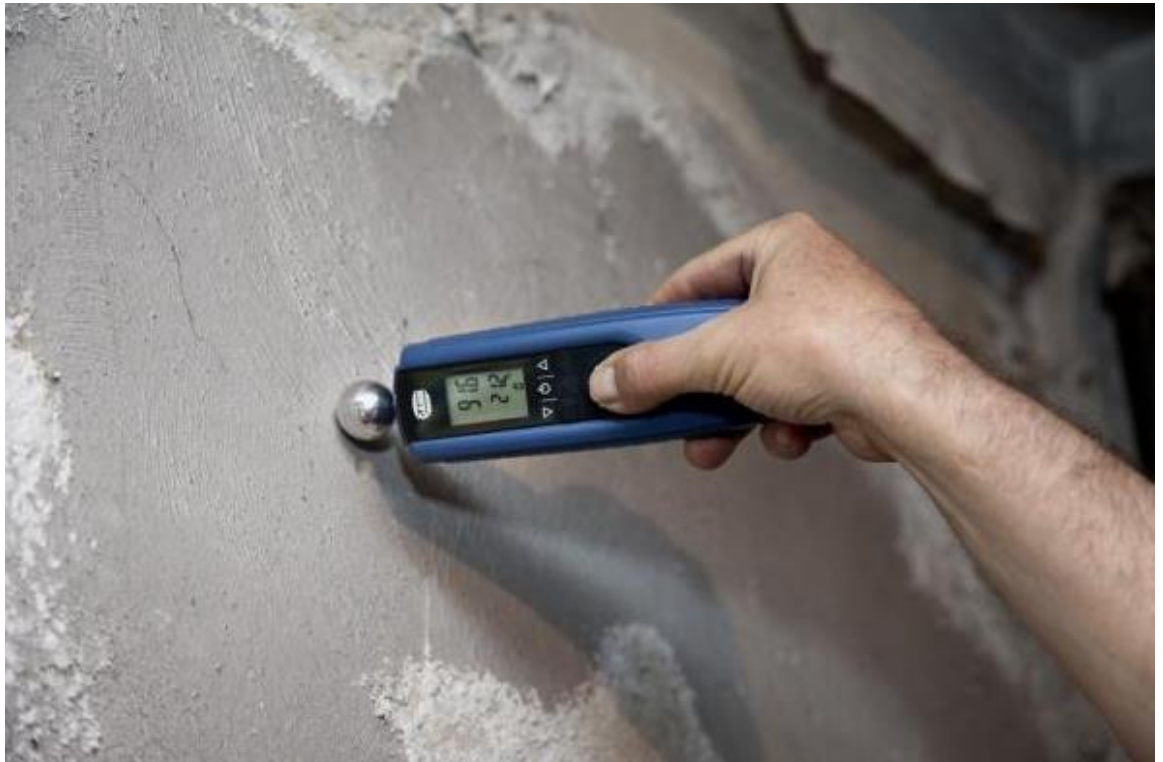
Kuva 12. Gann Hydromette BL Compact B on taskukokoinen pintakosteusmittari. [22.]
